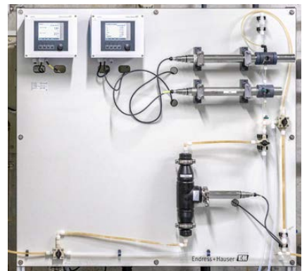
Memosens Wave CAS80E (oben rechts) im Feldtest in einem Wasserwerk
