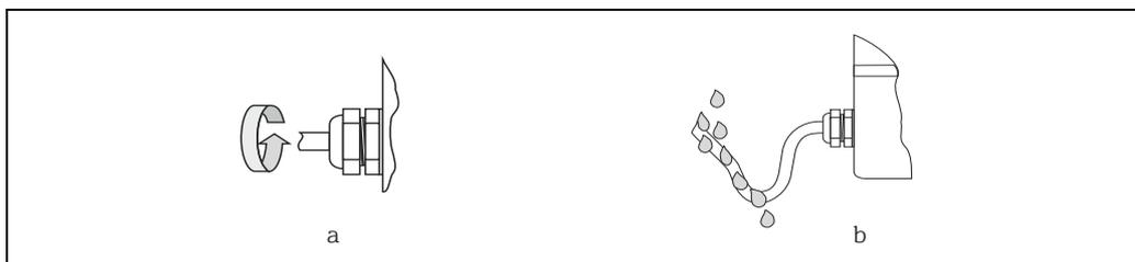
Рис. 48: Правила монтажа, кабельные вводы
