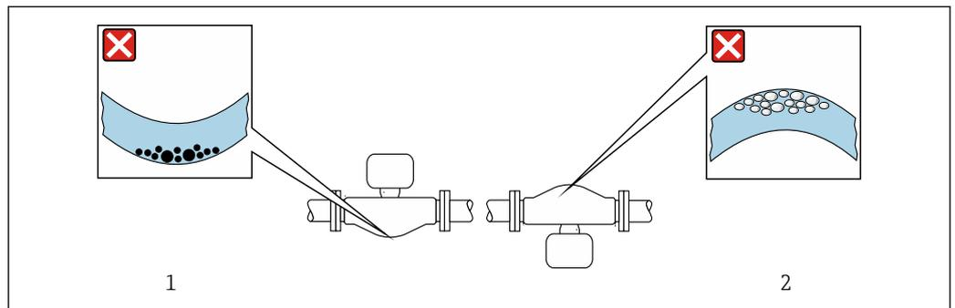
☒ 8 Position du capteur avec tube de mesure coudé
