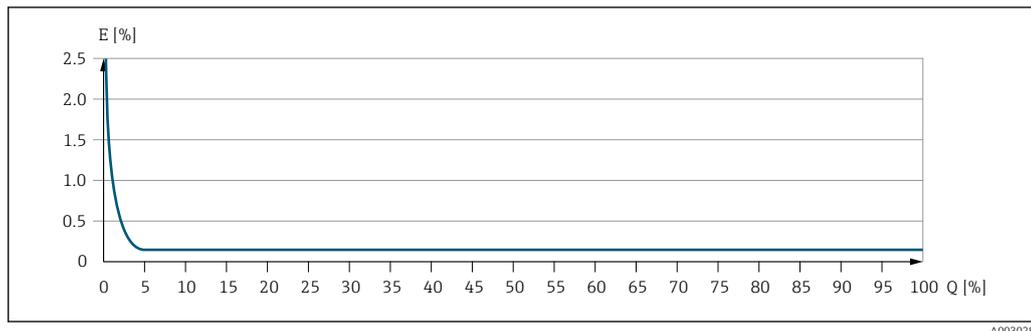
E Erreur de mesure maximale en % de m. (exemple)
