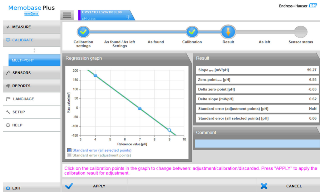
図 4 多点校正（「拡張診断機能」ライセンス）：調整点として標準液 4 と 7 を選択し、校正点として標準液 9 を選択
