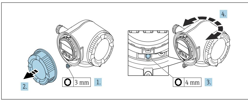
1. В зависимости от исполнения прибора: освободите зажим крышки клеммного отсека.
