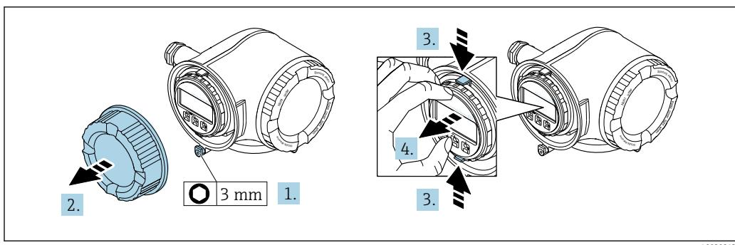
1. Ослабьте зажим крышки клеммного отсека.
