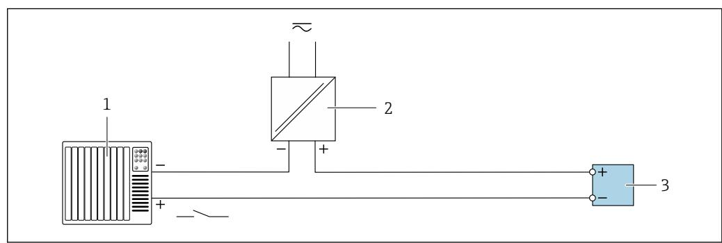
■ 18 Пример подключения для входного сигнала состояния
