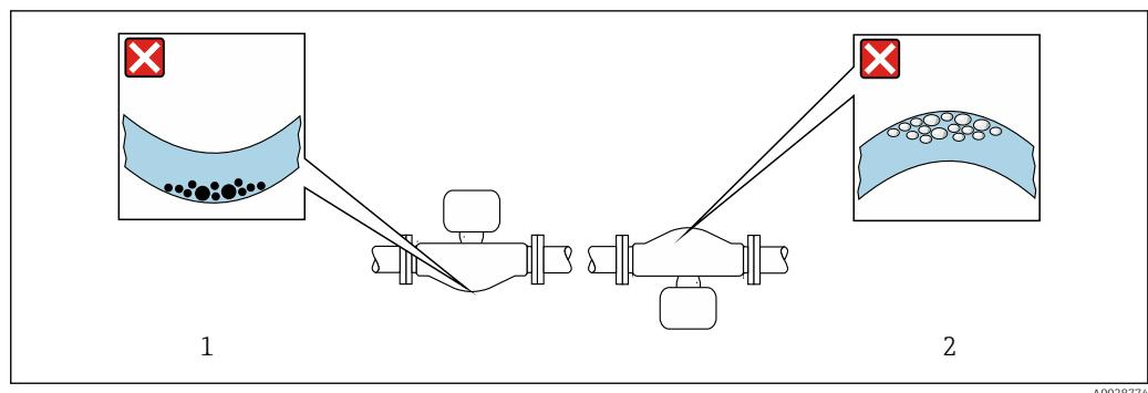
6 Монтажная позиция датчика с изогнутой измерительной трубкой
