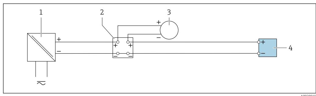
■ 17 Пример подключения для токового входа 4–20 мА
