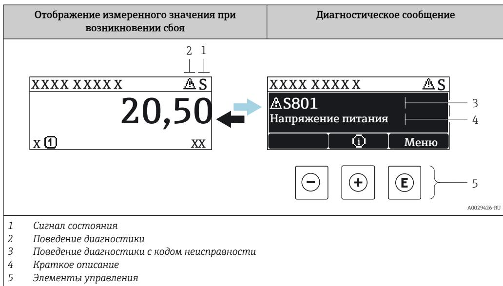
Если в очереди на отображение одновременно присутствуют два или более диагностических события, выводится только сообщение с максимальным приоритетом.
