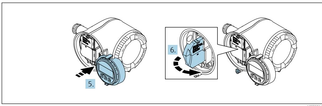
5. Присоедините держатель к краю отсека электронного модуля.
