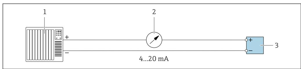
■ 12 Пример подключения для токового выхода 4-20 мА (активного)
