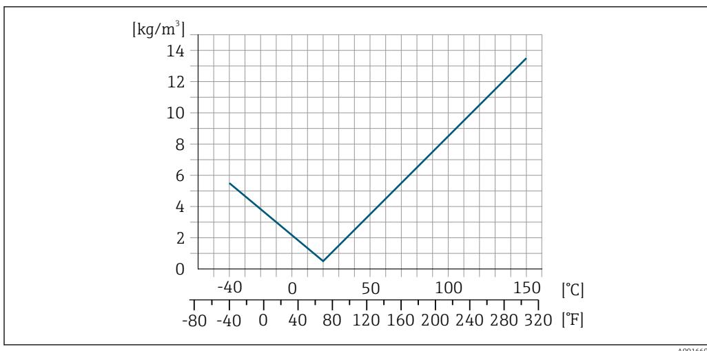
■ 33 Калибровка по плотности на месте эксплуатации, в примере при +20 °C (+68 °F)
