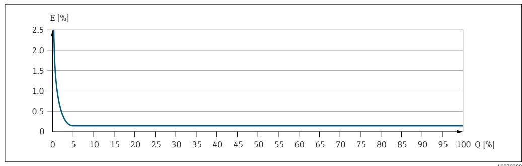
$E$  Максимальная погрешность измерения в % ИЗМ (пример)
