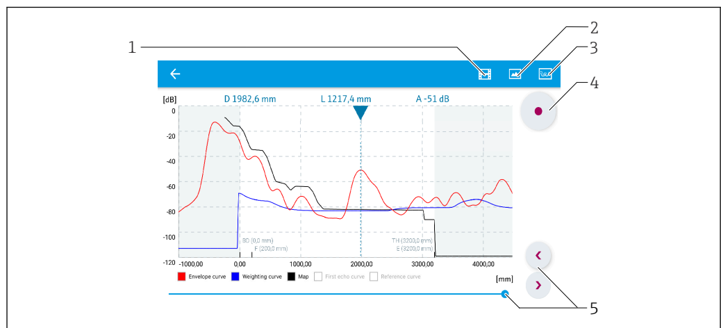
36 Visualizzazione della curva di inviluppo (esempio) in SmartBlue; vista Android
