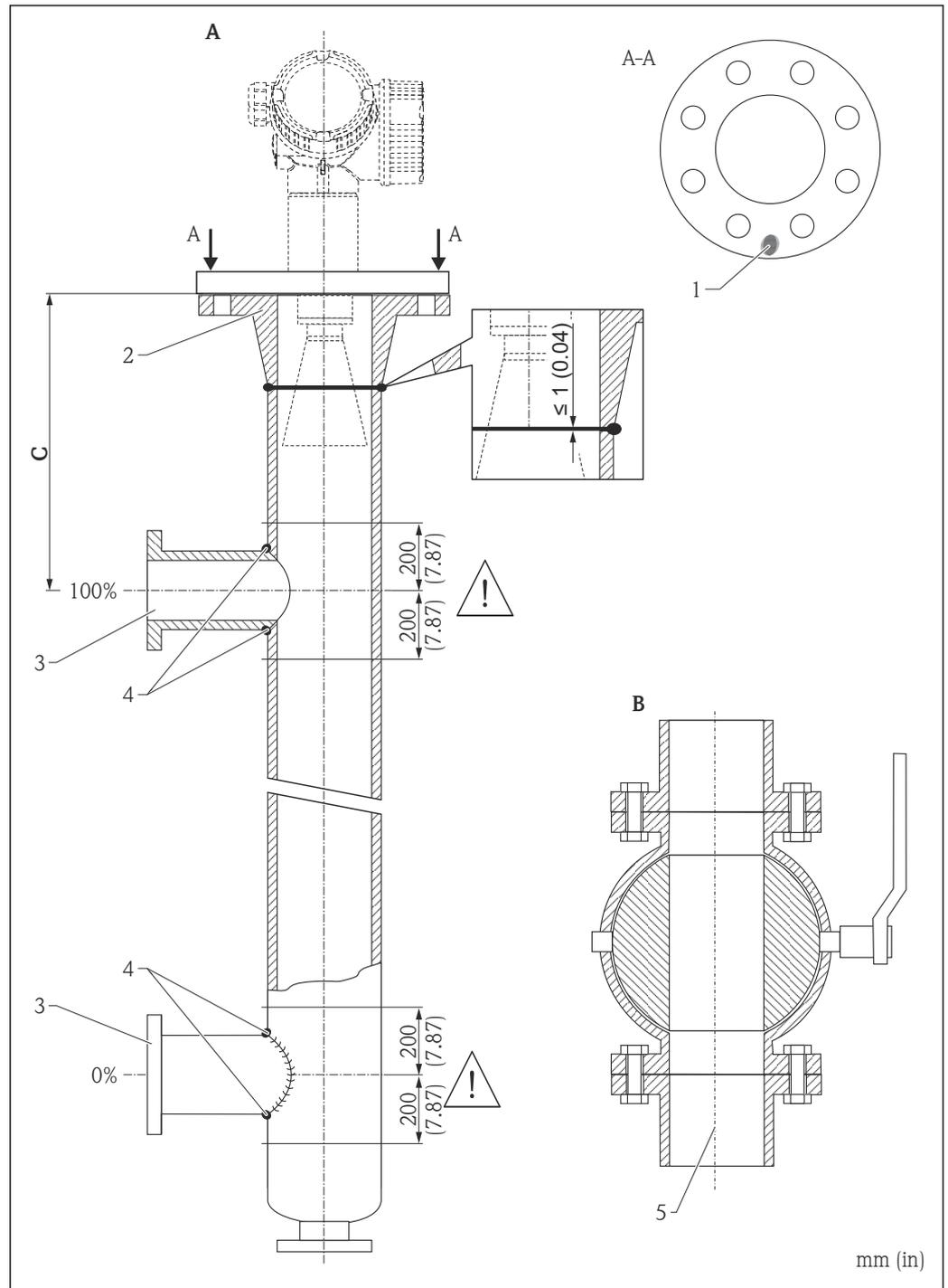
A Micropilot FMR50/FMR51/FMR52/FMR54: рупор 80 мм (3 дюйма)
