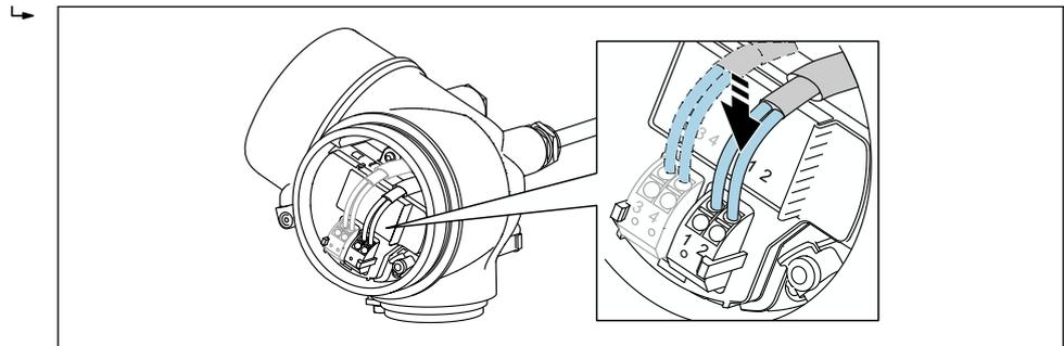
6. Cuando se utilicen cables blindados: conecte el blindaje de cables en la borna de tierra.
