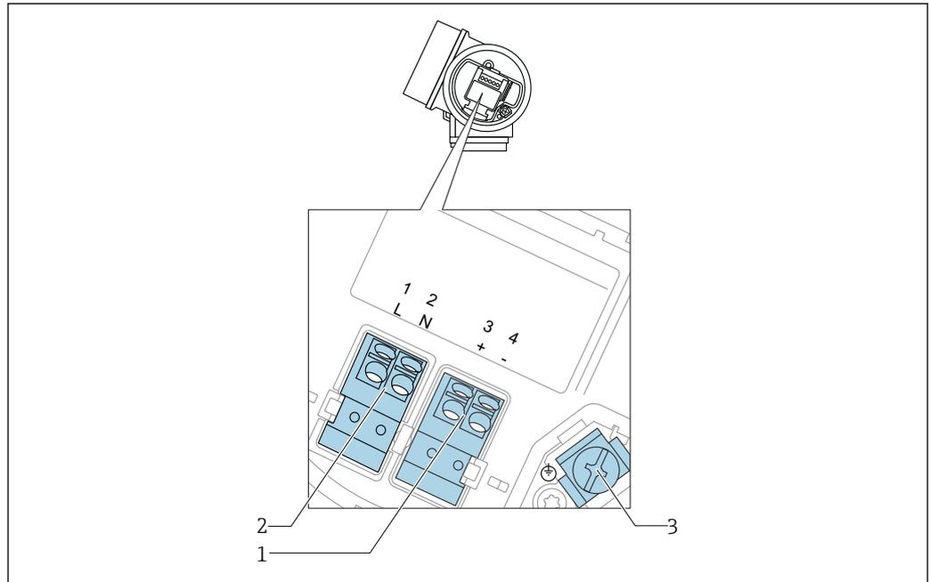
10 Asignación de terminales a cuatro hilos: 4-20 mA HART (90 ... 253 V<sub>AC</sub>)
