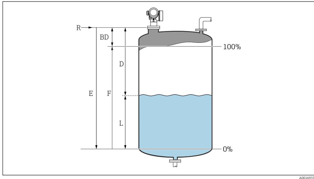
Fig. 24 Parámetros de configuración para la medición de nivel en líquidos
