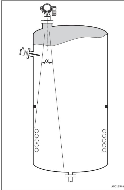
Evite la presencia de elementos instalados (detectores de nivel, sensores de temperatura, elementos de fijación, bocas para cierre al vacío, serpentines calefactores, obstáculos, etc.) que puedan interferir con el haz de señal. Tenga en cuenta el ángulo de abertura del haz
