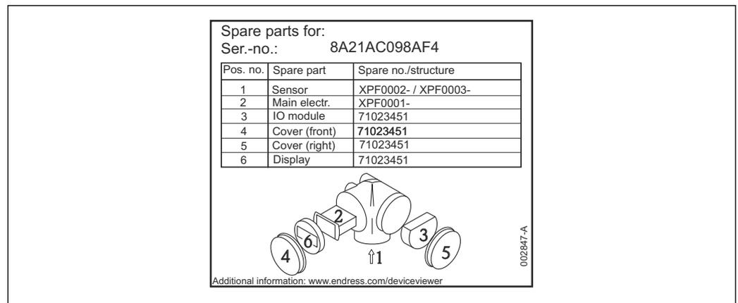
30 Ejemplo de una placa de identificación de piezas de repuesto situada en la tapa del compartimento de conexiones
