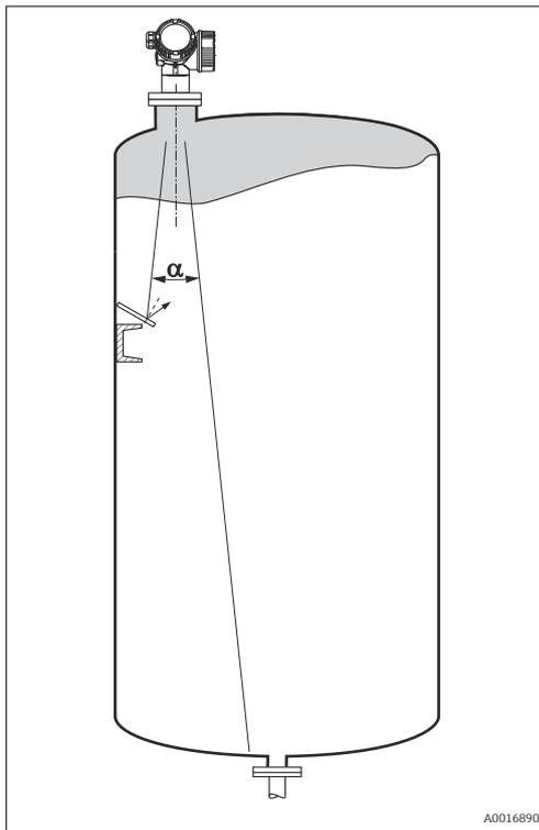
Unas pantallas metálicas montadas con cierta inclinación difunden la señal del radar y permiten reducir los ecos interferentes.
