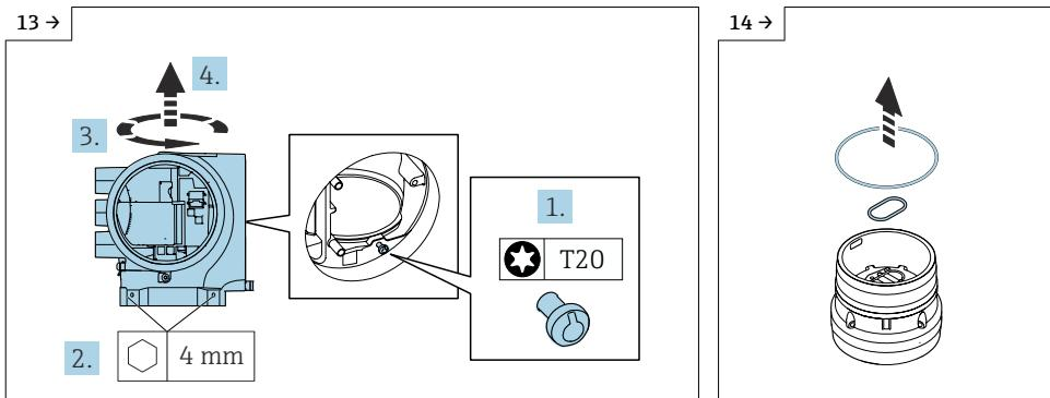
► Ausbau Messumformer in explosionsgeschützter Ausführung: Schrauben lösen und Messumformer drehen und hochziehen.
