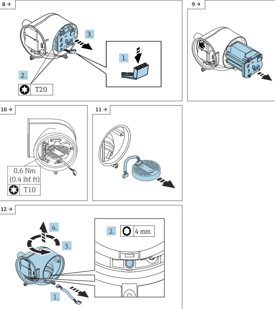
► Ausbau Messumformer in nicht explosionsgeschützter Ausführung:
