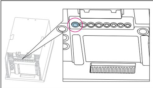
Faire passer le câble d'alimentation électrique, qui est fourni par le client sur l'emplacement de montage, à travers le presse-étoupe indiqué.
