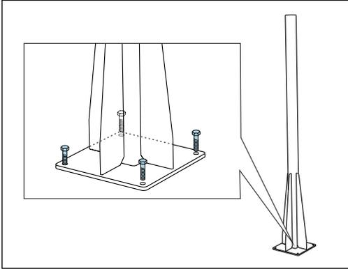
Ériger la colonne et la monter de façon sûre sur la fondation à l'aide de 4 vis de fixation (à fournir par le client <sup>1)</sup>).
