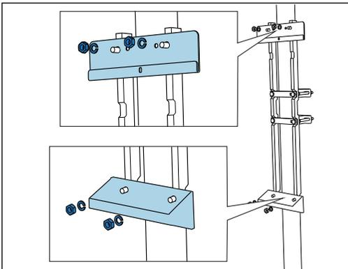
Monter l'unité de support mural (contenue dans la livraison de l'analyseur) sur le dispositif de retenue de la colonne.
