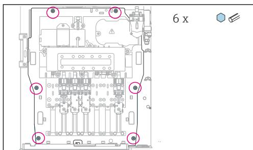
Løsne de 6 skruene på holderplaten med en unbrakonøkkel.
