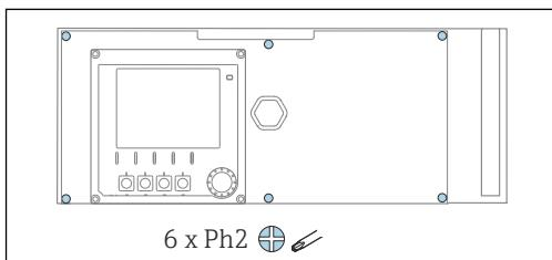
Løsne de 6 skruene på elektronikkromdekselet med en Phillips-skrutrekker og fold ut dekselet mot forsiden.
