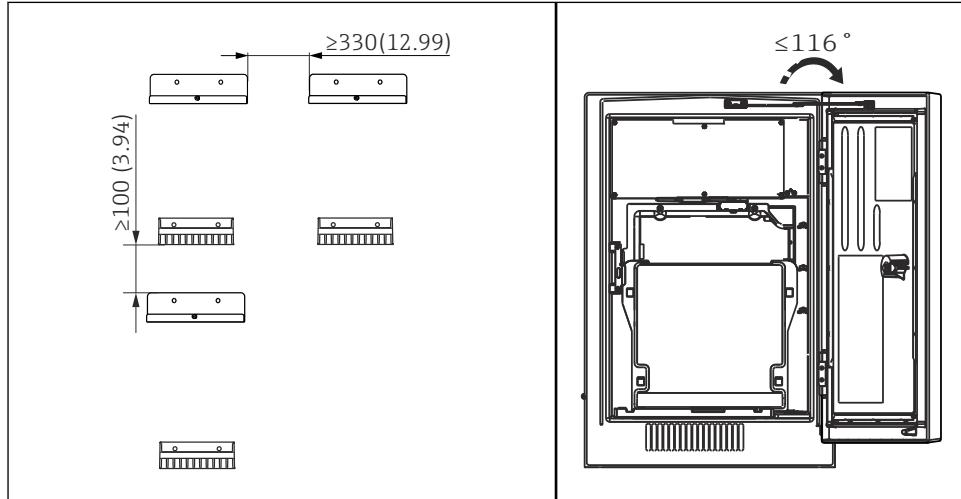
■ 5 Minste påkrevde monteringsavstand. Teknisk enhet ■ 6 Største åpningsvinkel mm (in).
