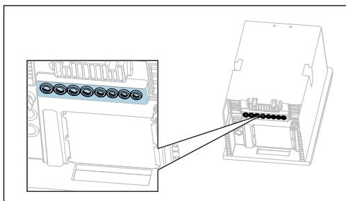
Før kablene gjennom kabelmuffene på bunnen av enheten.
