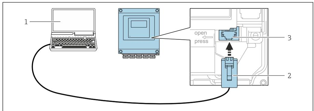
36 Conexão através de Interface de operação (CDI-RJ45)
