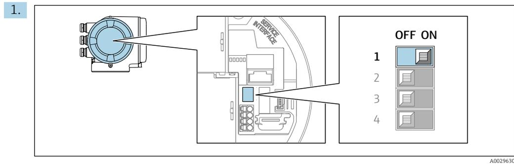
O ajuste da chave de proteção contra gravação (WP) no módulo de eletrônica principal para a posição **ON** habilita a proteção contra gravação de hardware.
