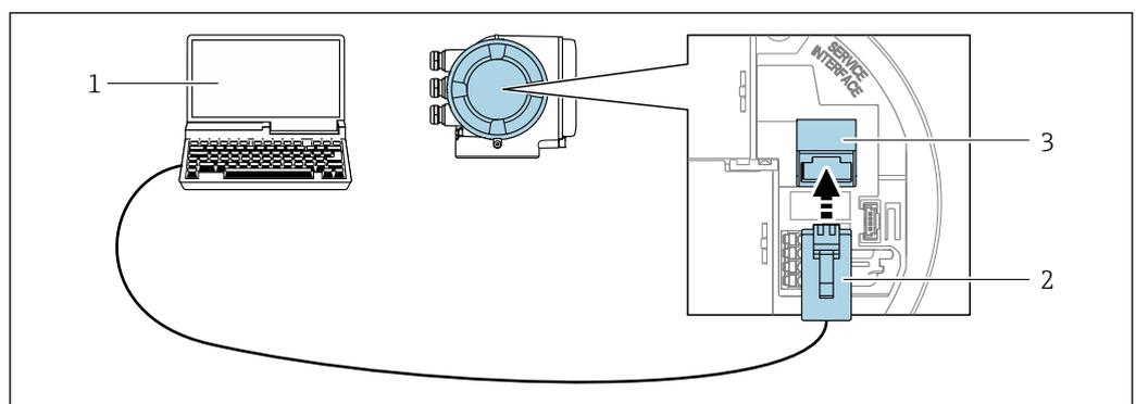
37 Conexão através de Interface de operação (CDI-RJ45)
