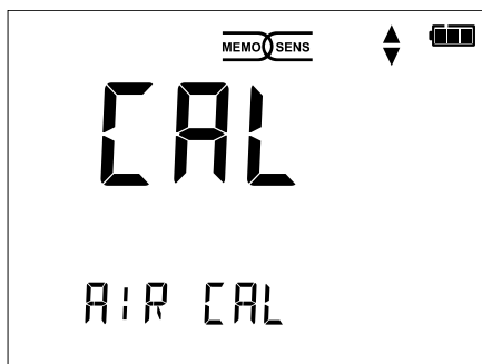
Calibração de oxigênio – passo 1 (calibração ao ar)
