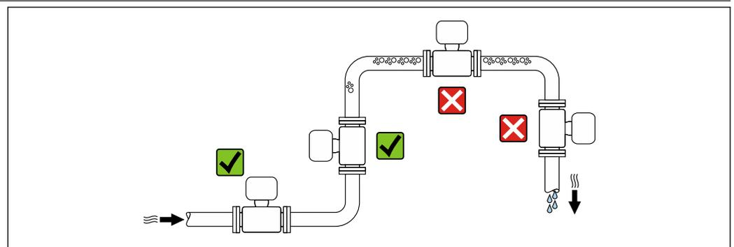
Para evitar erros de medição resultantes do acúmulo de bolhas de gás no tubo de medição, evite os seguintes locais de instalação no tubo:
