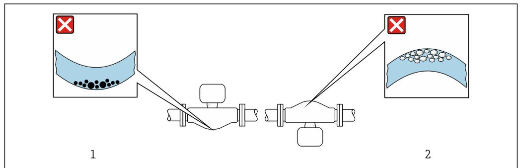
☒ 21 Direção do sensor com tubo de medição curvado
