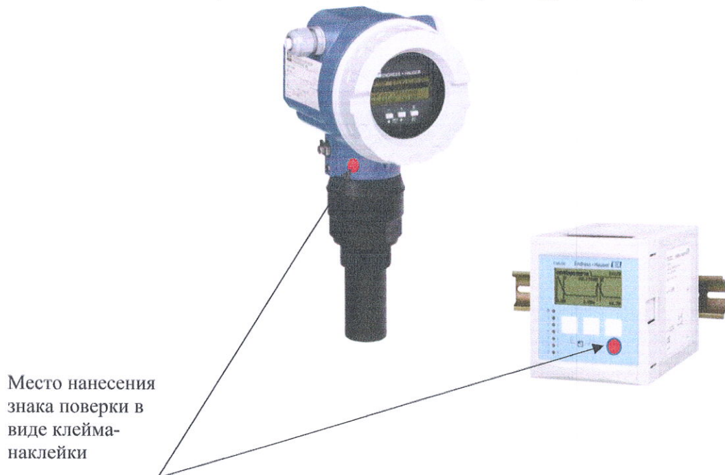
Рисунок В.1 – Схема пломбировки уровнемера
