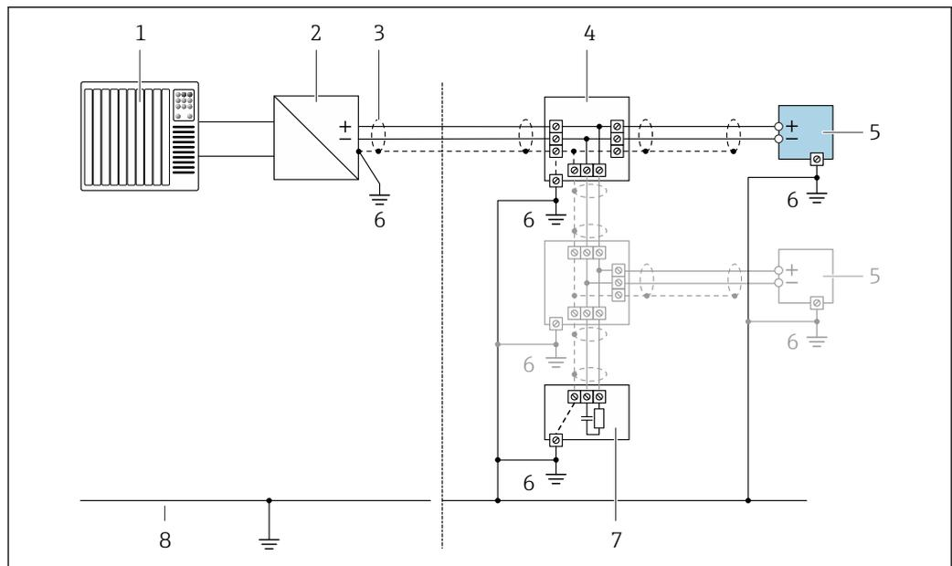
图 7 PROFIBUS PA 的连接实例
