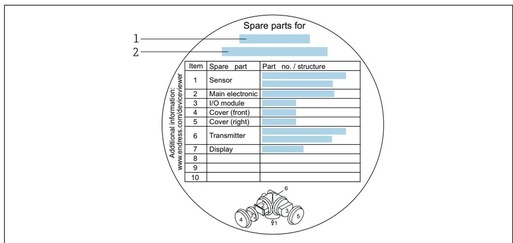
图 23 接线腔盖中的“备件概述标签”示例
