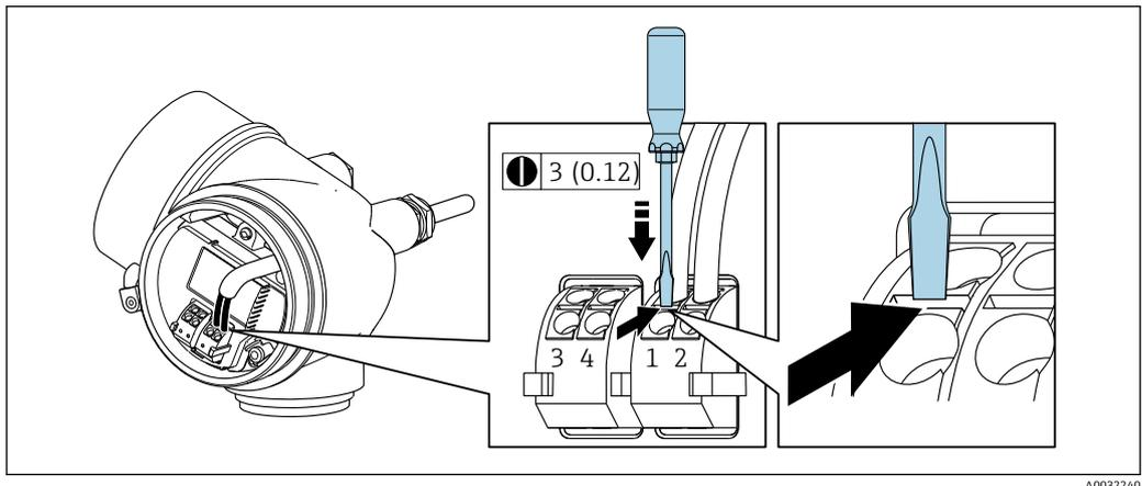
▶ 将一字螺丝刀插入两个接线端子的孔口间隙中，并下压。同时向外拉电缆，从接线端子上将电缆拆卸下来。
