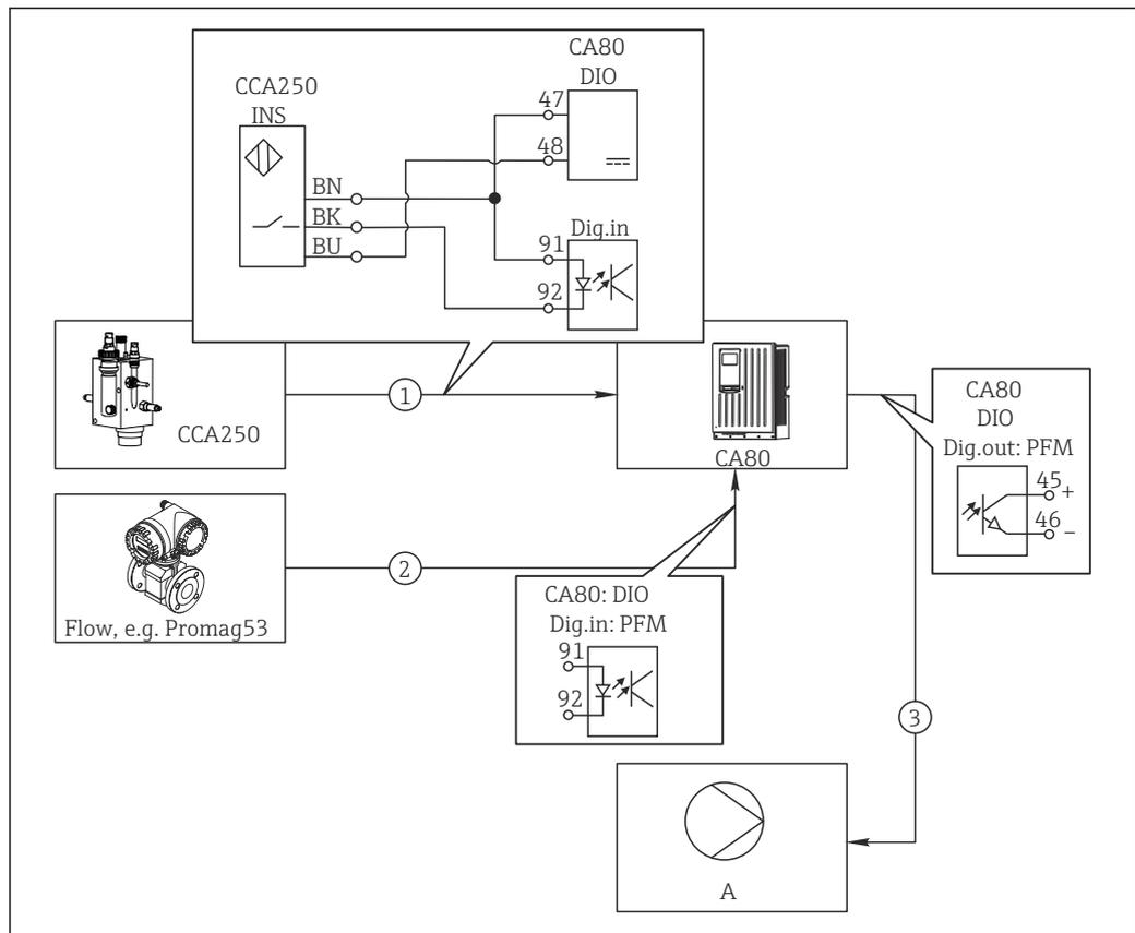
50 Exemplo de regulagem de cloro com controle feedforward
