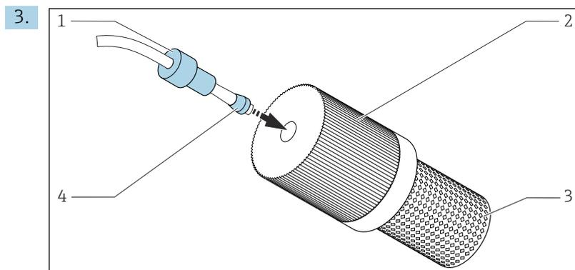
49 Instalação do filtro de sucção (fornecido) na mangueira de amostragem
