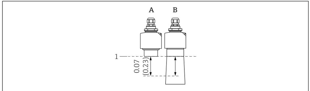
1 Distância de bloqueio do sensor ultrassônico. Unidade de engenharia m (pés)
