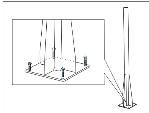
Levante el poste y móntelo de forma segura sobre los cimientos usando 4 tornillos de fijación (que el cliente mismo ha de procurarse <sup>1)</sup>).
