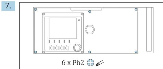
Afloje los 6 tornillos de la tapa del compartimento de la electrónica con un destornillador Phillips y abra la tapa hacia delante.
