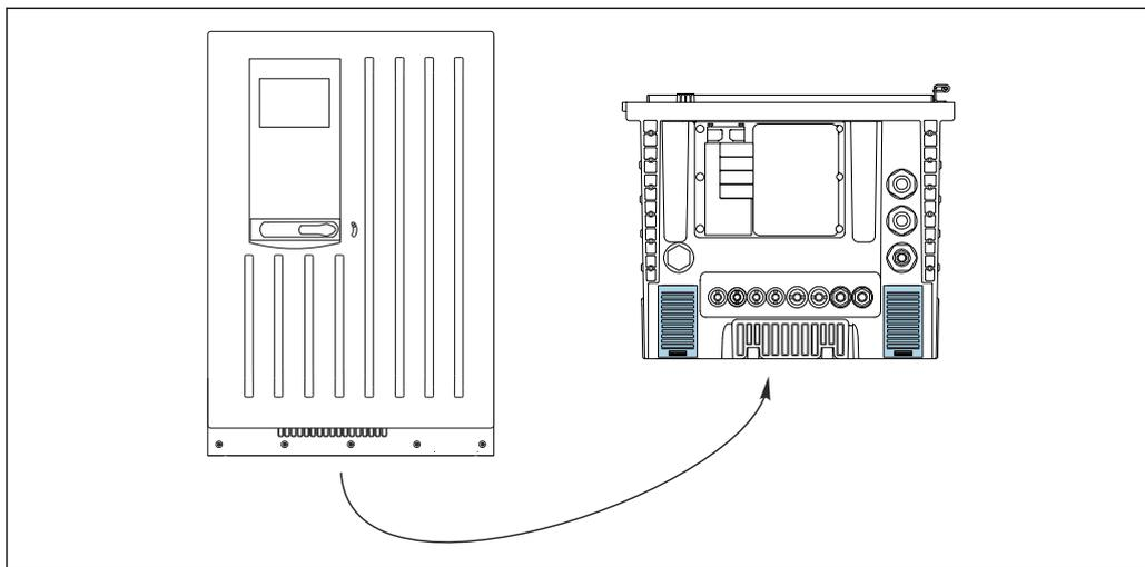
80 Malla del ventilador en la parte inferior
