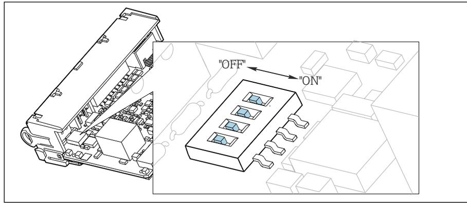
51 Microinterruptores para el resistor de terminación interno
