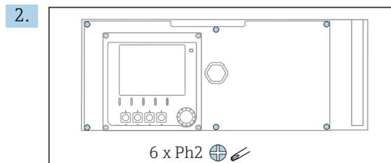
Afloje los 6 tornillos de la tapa del compartimento de la electrónica con un destornillador Phillips y abra la tapa hacia delante.
