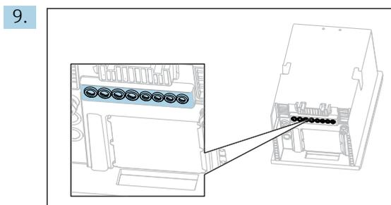
Haga pasar los cables por los prensaestopas que hay en la parte posterior del equipo.
