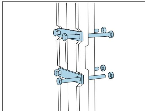
Fije con las tuercas la abrazadera de la sujeción del poste a las varillas de retención y al poste.
