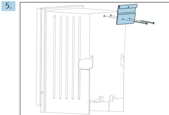
Atornille al analizador el soporte de suspensión de la unidad de soporte en pared (incluido en el alcance del suministro con el analizador).
