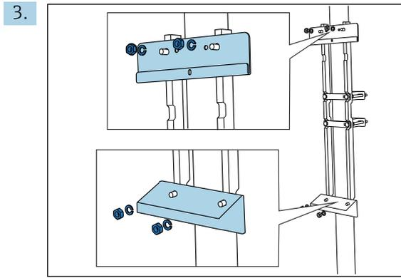
Monte la unidad de soporte en pared (incluido en el alcance del suministro con el analizador) en la sujeción del poste.
