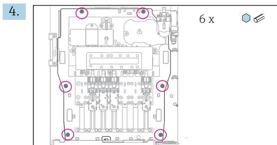
Afloje los 6 tornillos de la placa de soporte con una llave Allen.
