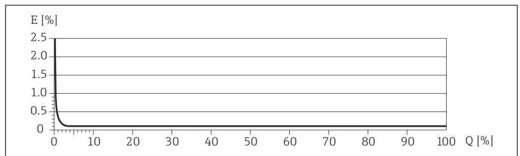
E Errore: errore di misura massimo in % v.i. (esempio)
