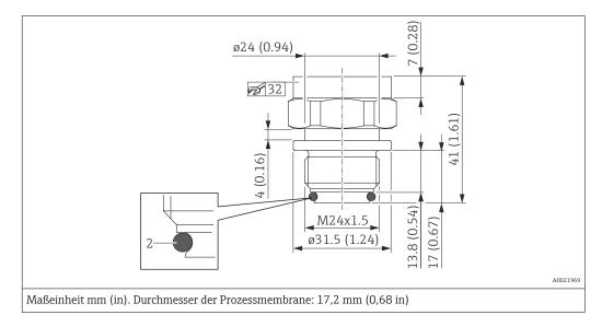
Option  $^{1)}$ Bezeichnung Dichtung Werkstoff Gewicht Zulassung kg (lbs)  $M24 \times 1,5^{2}$ EPDM O-Ring (2), vormontiert 0,150 (0.33) EHEDG, 3A, CRN X2J 316L M24 x 1,5<sup>2)</sup> FKM O-Ring (2), vormontiert 316L 0,150 (0.33) EHEDG, 3A, CRN ХЗЈ
