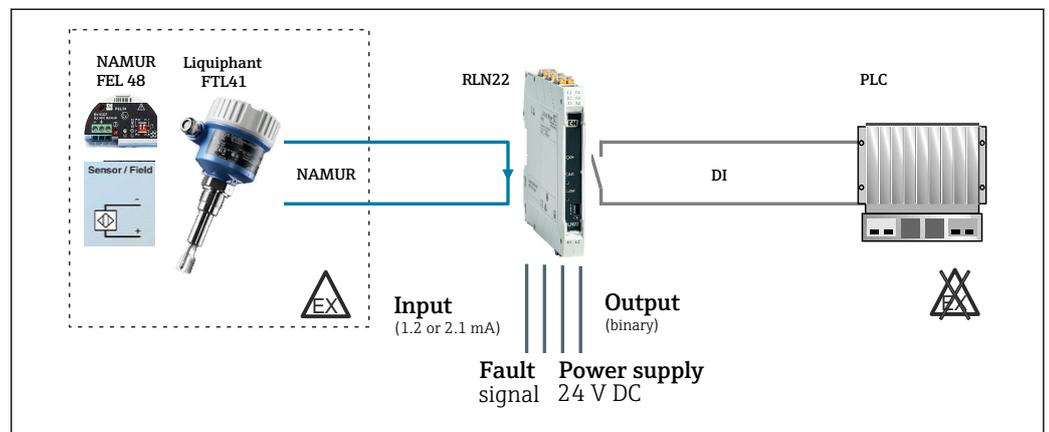
20 rilevamento di soglia NAMUR, Liquiphant FTL41 con elaborazione NAMUR FEL48 nell'area pericolosa
