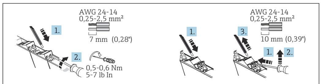
5 Connessione elettrica mediante morsetti a vite (sinistra) e morsetti a pressione (destra)
