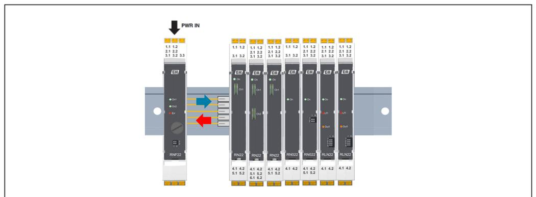
13 Alimentazione tramite moduli di alimentazione e di messaggi di errore RNF22
