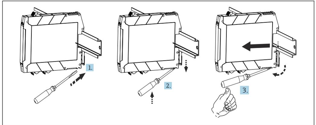
4 Smontaggio del dispositivo per guida DIN
