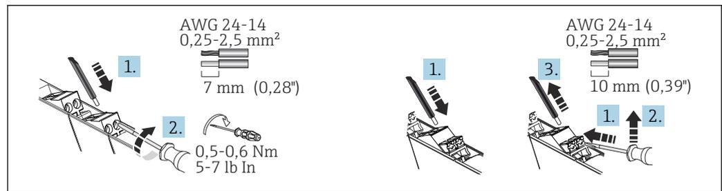
9 Collegamento elettrico con morsetti a vite (a sinistra) e morsetti push-in (a destra)
