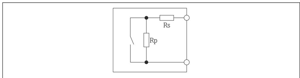
22 Circuito di resistenza per monitoraggio circuiti (cortocircuito e interruzione)
