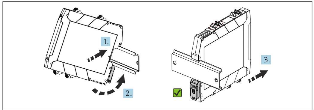
10 Montaje sobre rail DIN
