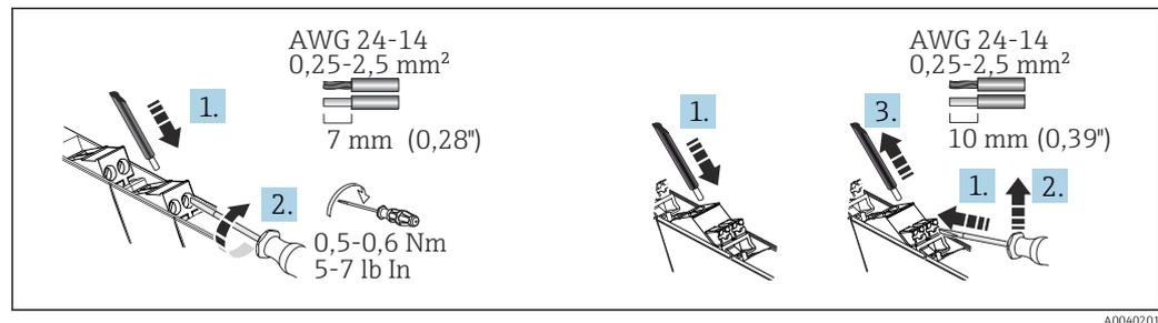
5 Conexión eléctrica con terminales de tornillo (izquierda) y con terminales de push-in (derecha)
