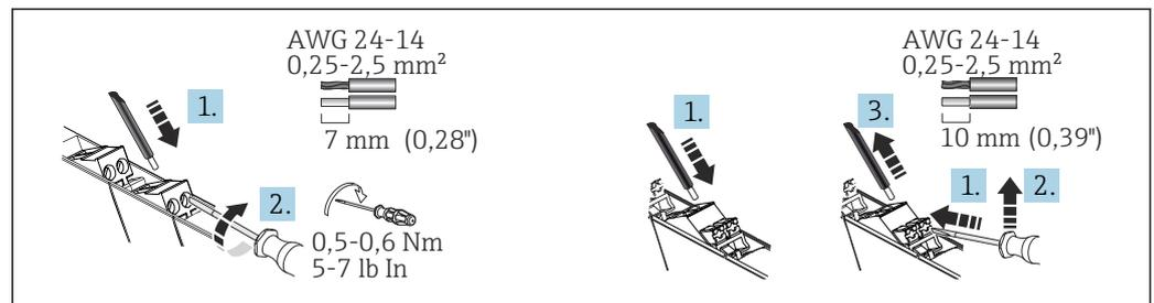
9 Conexión eléctrica con terminales de tornillo (izquierda) y con terminales de push-in (derecha)
