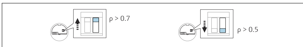
43 Położenie przełącznika gęstości na wkładce elektroniki
