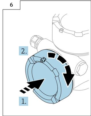
Ausbau von Anzeige und Elektronik
