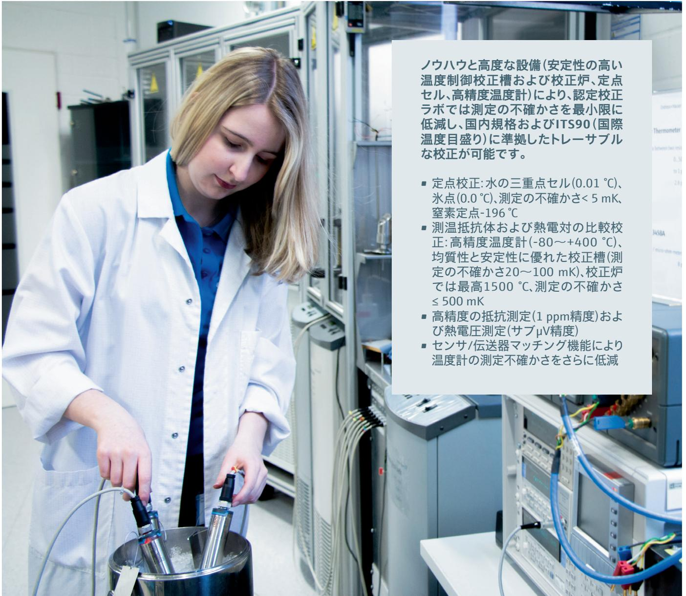
ノウハウと高度な設備(安定性の高い温度制御校正槽および校正炉、定点セル、高精度温度計)により、認定校正ラボでは測定の不確かさを最小限に低減し、国内規格およびITS90(国際温度目盛り)に準拠したトレーサブルな校正が可能です。
