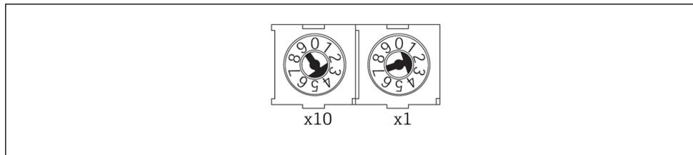
Impostare l'indirizzo PROFIBUS sul gateway utilizzando i commutatori, ad esempio indirizzo = 42 (4 x 10) + (2 x 1). Gli indirizzi da 0 a 2 vengono solitamente usati per i PROFIBUS master. Ciascun dispositivo PROFIBUS necessita di un indirizzo univoco.
