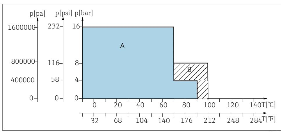
57 Взаимозависимость между давлением и температурой для базового исполнения из материала PVDF и проводящего материала PVDF (CPA871-\*\*\*\*\*E/F\*\*\*\*\*)
