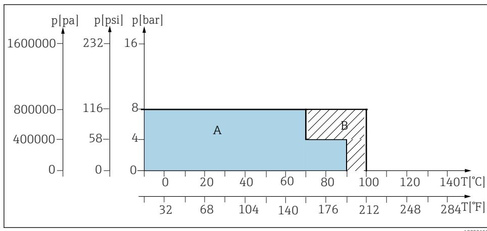
■ 53 Зависимости «давление/температура» для базового исполнения, материалы: PVDF и проводящий PVDF
