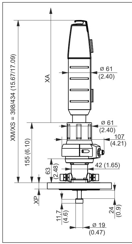
5 Ручной привод, укороченное исполнение, размеры в мм (дюймах)
