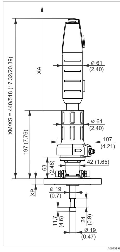
**7** Ручной привод, удлиненное исполнение, размеры в мм (дюймах)
