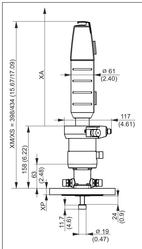
4 Пневматический привод, укороченное исполнение, размеры в мм (дюймах)
