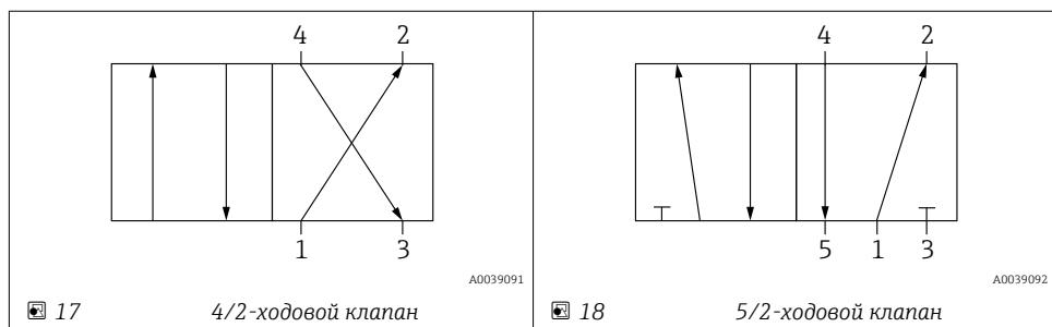
Штуцер 1 предназначен для подсоединения к источнику сжатого воздуха.
