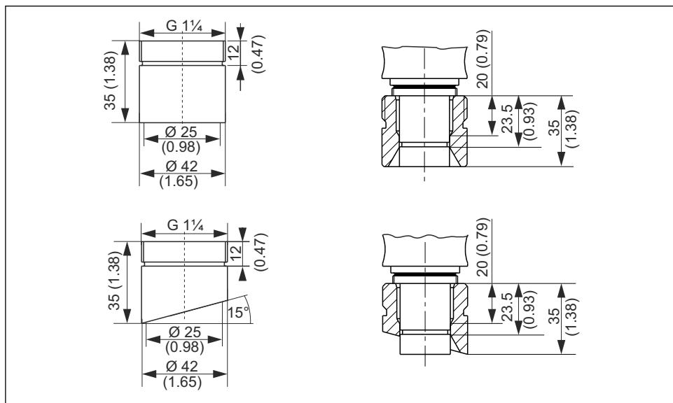
■ 49 Приварной адаптер (предохранительный патрубок), размеры в мм (дюймах)
