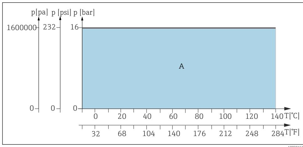
56 Взаимозависимость между давлением и температурой для базового исполнения и исполнения с погружной камерой из материалов 1.4404, Alloy C22 и PEEK (CPA871-\*\*\*\*\*E/F\*\*\*\*\*)
