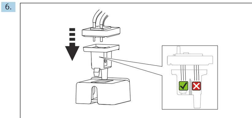
Replacer le couvercle en caoutchouc en veillant à ce que les capillaires se trouvent dans la chambre de mesure.
