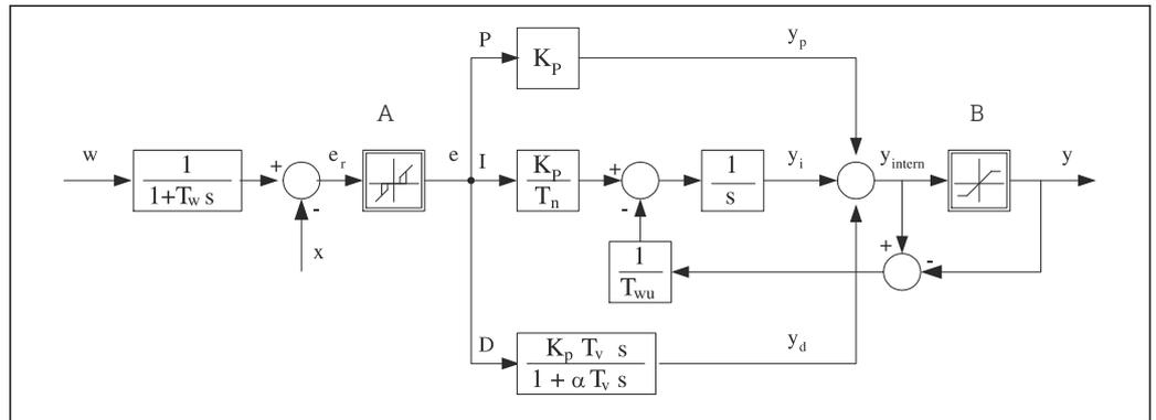
70 Diagramme de principe de la structure du régulateur
