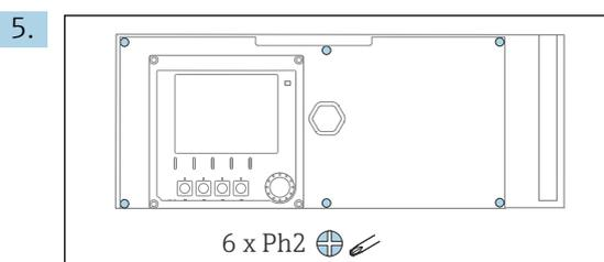
Dévisser les 6 vis du couvercle du compartiment de l'électronique à l'aide d'un tournevis cruciforme et rabattre le couvercle vers l'avant.
