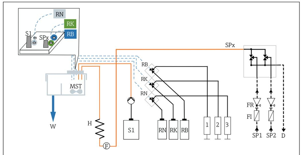
58 Schéma de raccordement des tuyaux pour la version 1/2 voies
