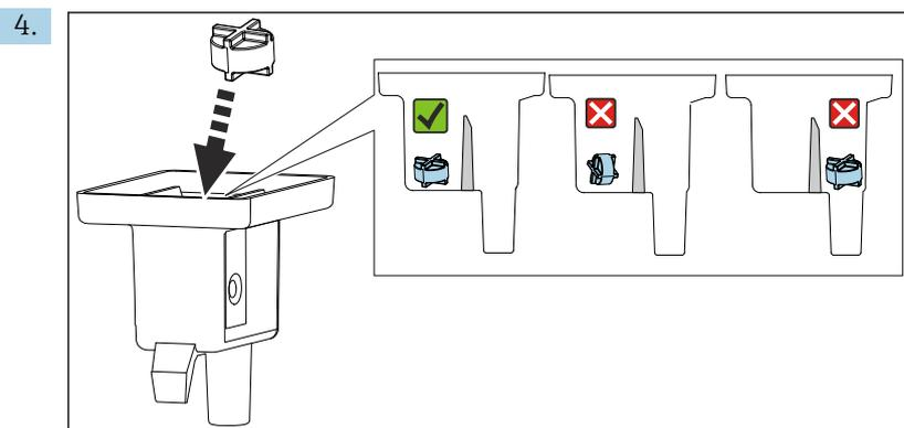
Replacer l'agitateur magnétique dans la chambre de mesure en s'assurant qu'il est à plat et bien à l'intérieur de la chambre de mesure.
