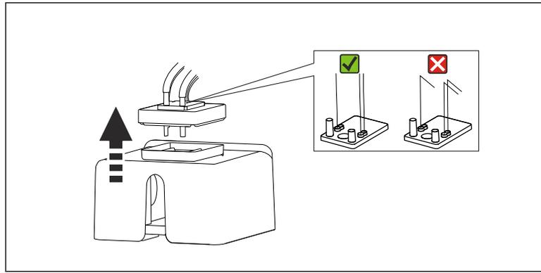
Soulever le couvercle en caoutchouc de la cuvette. Il ne doit pas y avoir de plis dans les capillaires au niveau du support de capillaire ou au niveau des vannes, et il ne faut pas retirer les capillaires du connecteur de tuyau.
