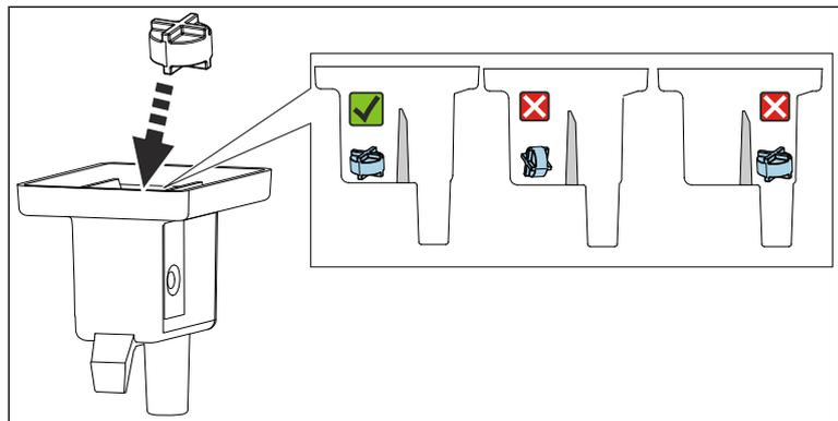
Placer l'agitateur magnétique dans la chambre de mesure en s'assurant qu'il est à plat et dans la chambre de mesure.
