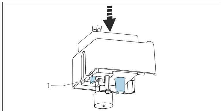
Engager la cuvette avec l'agitateur magnétique et le couvercle dans le support. S'assurer que la languette (1) s'enclenche.
