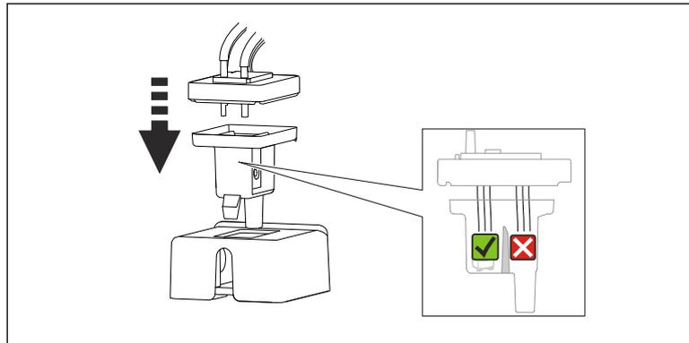
Replacer le couvercle en caoutchouc de la cuvette et veiller à ce que tous les capillaires se trouvent dans la chambre de mesure.
