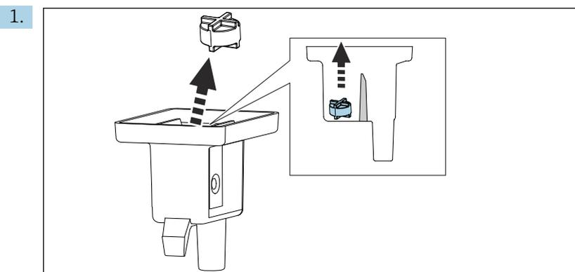
Retirer l'agitateur magnétique de la chambre de mesure.
