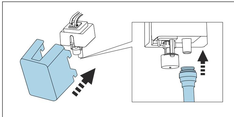
Raccorder de nouveau le tuyau d'évacuation "W" et fixer de nouveau le couvercle.
