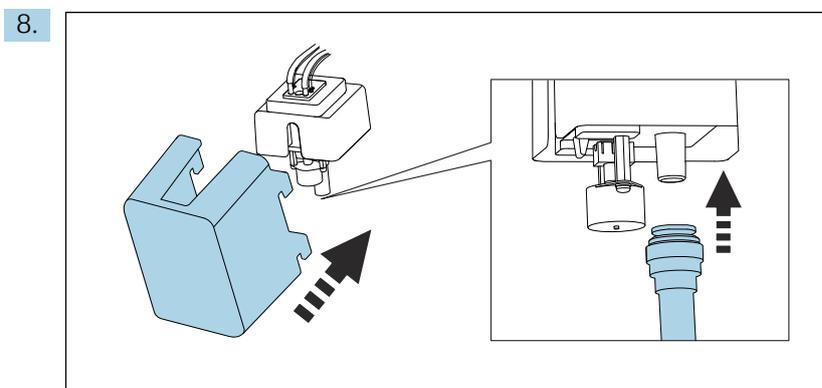
Raccorder à nouveau le tuyau de sortie "W" et refixer le couvercle.
