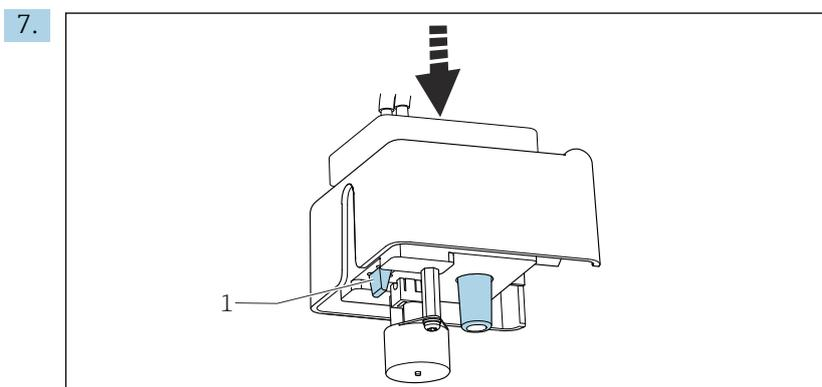
Pousser la cuvette avec l'agitateur magnétique et le couvercle dans le support. S'assurer que la languette (1) s'enclenche.
