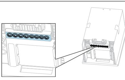
将电缆穿过设备底部的电缆缆塞。
