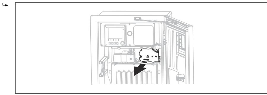
8. 在外壳内敷设电缆，使得裸露的电缆屏蔽线插入至其中一个电缆夹中，电缆线芯能够轻松连接至插入式接线端子。
