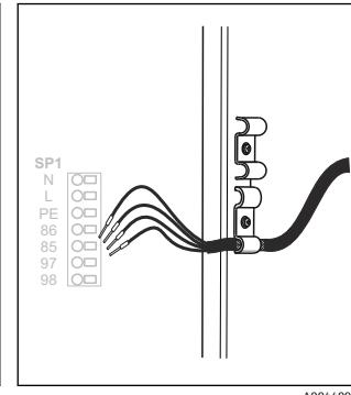
图 16 端接电缆
