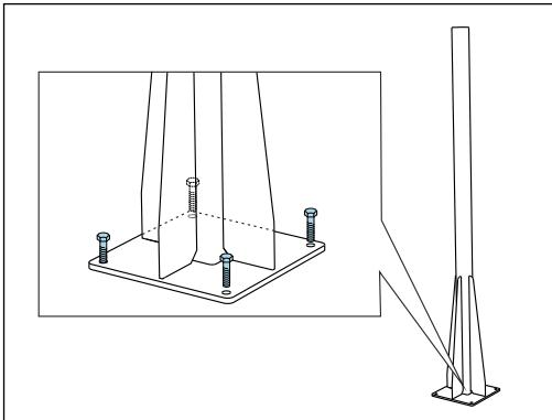
架设立柱并使用 4 颗固定螺丝（由客户提供<sup>1)</sup>）将其牢固地安装在底板上。
