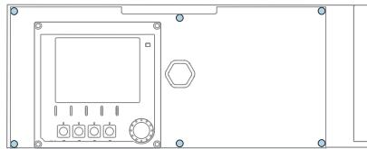
使用十字螺丝刀松开电子腔盖上的六颗螺丝，并向前叠起盖板。
