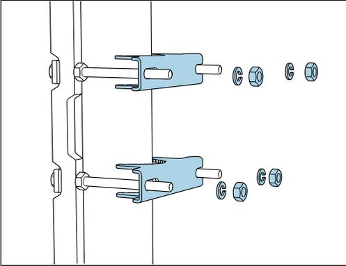
安装对应的部件，并使用弹簧垫圈和螺母固定立柱固定器。
