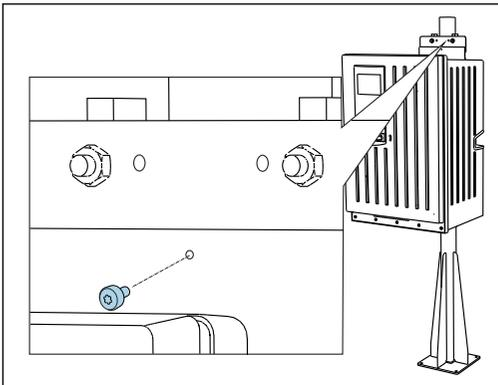
使用包装中的螺丝将上部墙挂支架固定到位。
