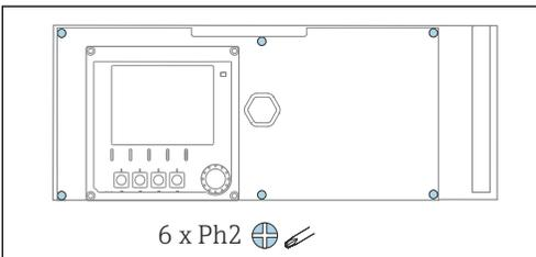
使用十字螺丝刀松开电子腔盖上的六颗螺丝，并向前叠起盖板。
