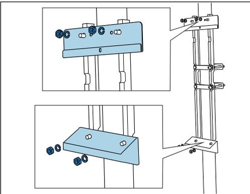
将墙装架（随分析仪一起提供）安装在立柱固定器上。
