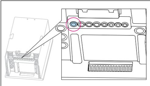
将用户现场自备的供电电缆插入至图示缆塞中。
