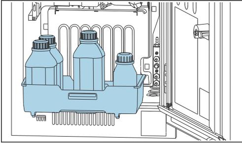
取出托盘：轻抬托盘底部凹槽，向前拉出托盘。
