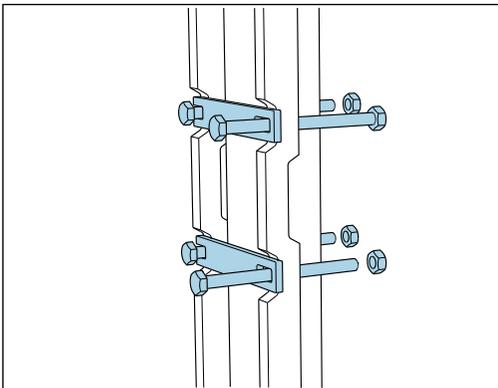
使用螺母将立柱固定器的夹具安装在固定杆和立柱上。
