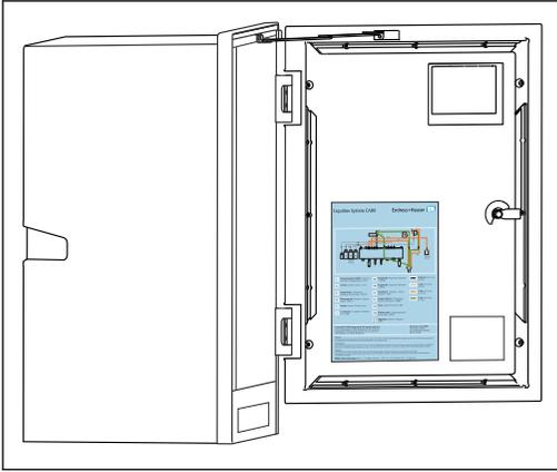
下列样品流路图与本文档同步发布。不同设备型号的样品流路图参见分析仪柜门的内侧。
