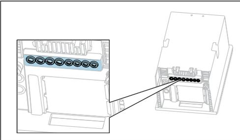
将电缆穿过设备底部的电电缆塞。
