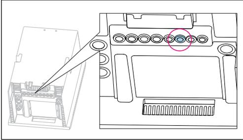
将伴热废液软管电缆插入至图示缆塞中。
