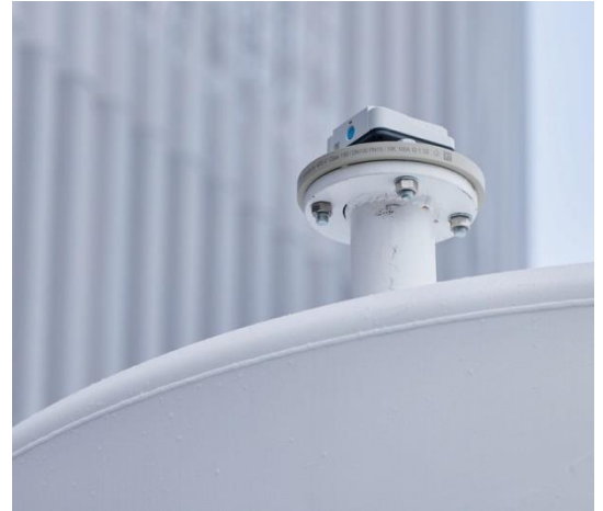
사일로 위에 장착된 센서: Micropilot FWR30 레벨 센서(배터리 방식)
