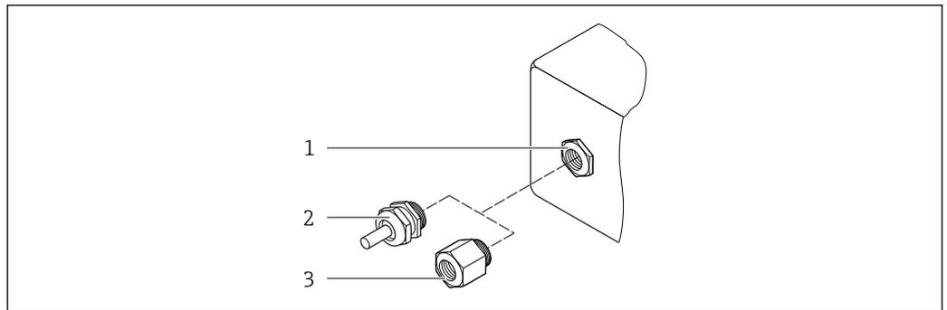
42 Mögliche Kabeleinführungen/-verschraubungen
