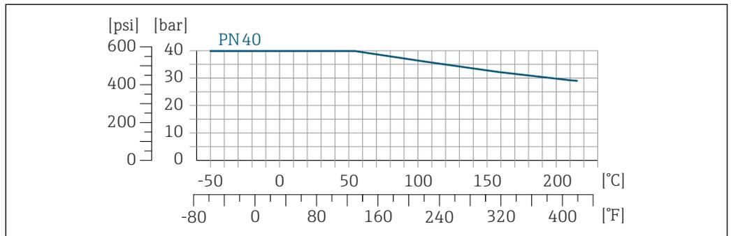
32 Losflansch mit Flanschwerkstoff: 1.4301 (F304), mediumsberührende Teile Alloy C22: 2.4602 (UNS N06022)
