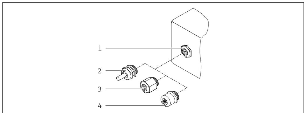
54 Mögliche Kabeleinführungen/-verschraubungen
