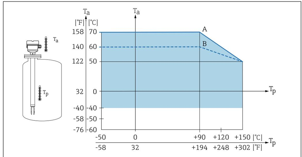
52 Température ambiante admissible  $T_a$  au boîtier en fonction de la température de process  $T_p$  dans la cuve :
