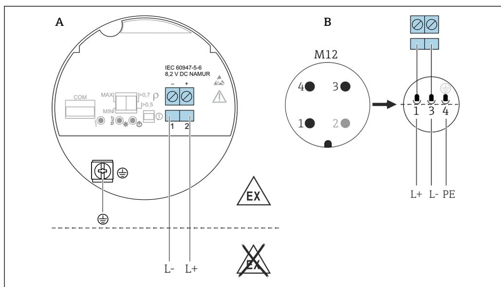
27 NAMUR 2 fils  $\geq 2,2$  mA /  $\leq 1,0$  mA, électronique FEL68
