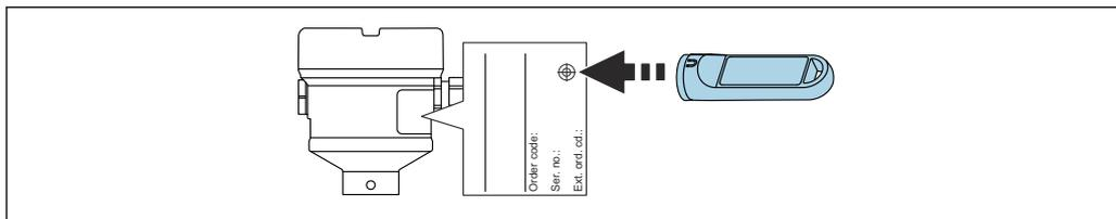
41 Test de fonctionnement avec l'aimant de test
