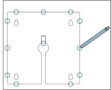
1. Montageplatte von außen an die Schaltschranktür halten. Dafür die Stelle wählen, an der Sie das Display einbauen wollen.
