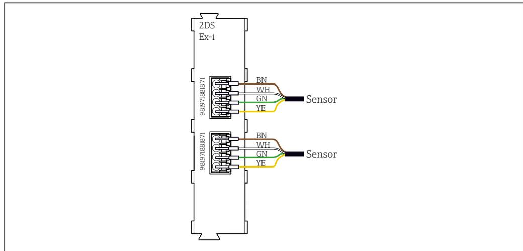
21 Sensoren ohne zusätzliche Versorgungsspannung am Sensorkommunikationsmodul Typ 2DS Ex-i
