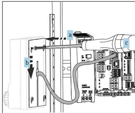
7. Die Montageplatte an der Innenseite auf die Schrauben stecken (a), sie nach unten schieben (b) und die Schrauben festziehen (c).
