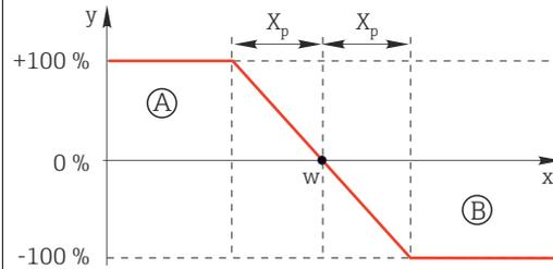
61 Rot: Überlagerung der Kurven der beiden 1-seitigen Regler.
