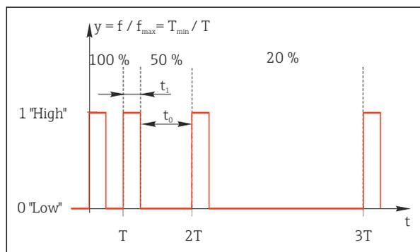
50 Typische Anwendung: Dosierpumpe
