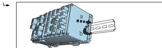
3. Halteklammern bis zum Klick nach oben schieben und so das Gerät auf der Hutschiene verankern.
