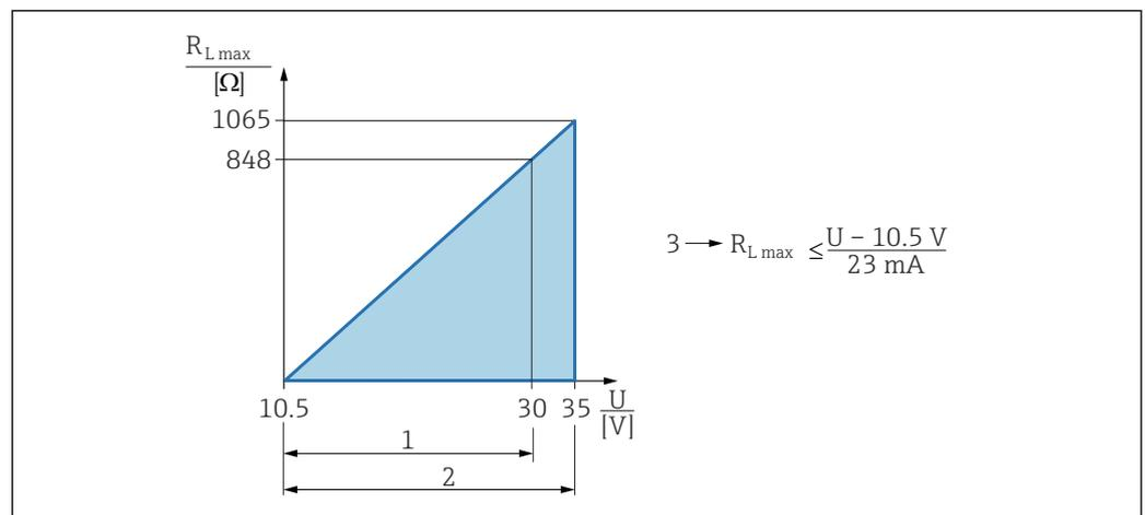
1 Spannungsversorgung 10,5 ... 30 VDC Ex i
