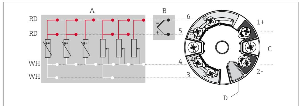
3 Klemmenanschlussbelegung des Kopftransmitters
