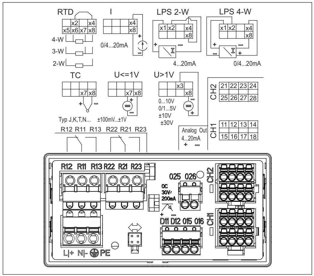
図 13 プロセス表示器の端子の割当て（リレー（端子 Rx1-Rx3）およびチャンネル 2（端子 21-28 および 025/026）はオプション）。注意：電源異常が発生した場合のリレー接点位置を図示
