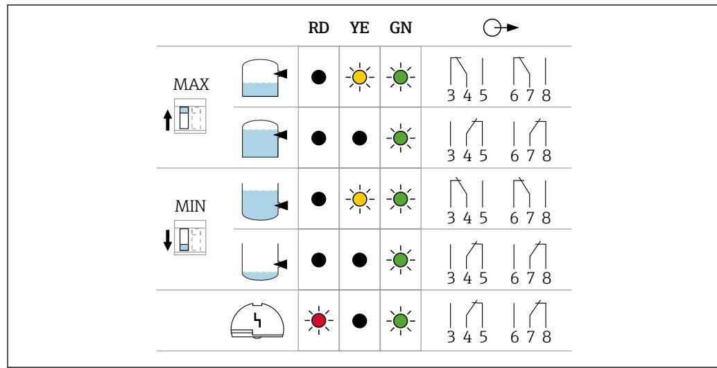
图 24 电子插件 FEL64 DC 的继电器响应和故障信号
