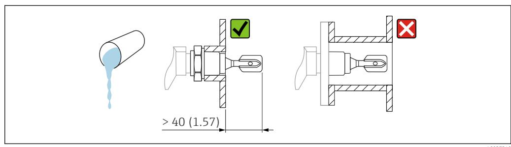
图 6 安装实例: 测量高粘度液体。测量单位 mm (in)
