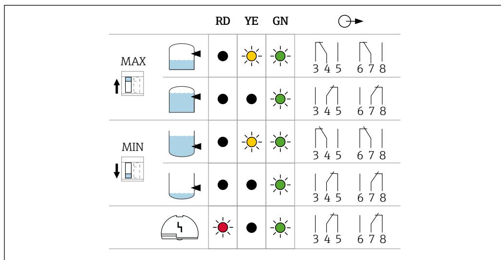
图 22 电子插件 FEL64 的继电器响应和故障信号
