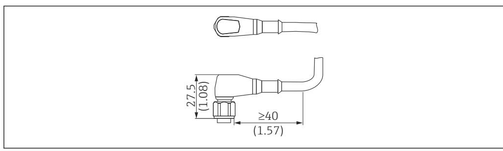
图 46 M12 插头，IP69 防护等级。测量单位 mm (in)
