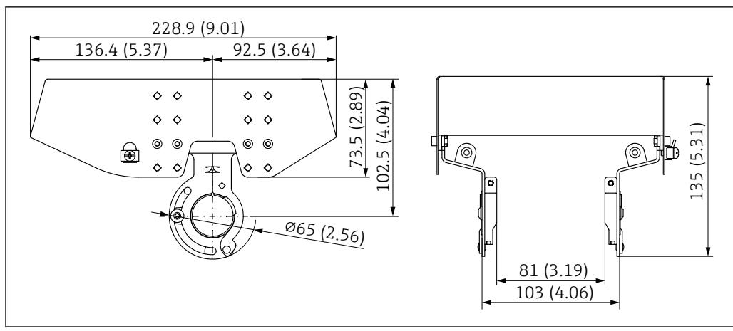
图 44 防护罩，适用双腔室铝外壳。测量单位 mm (in)
