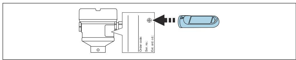
图 41 使用测试磁铁进行功能测试
