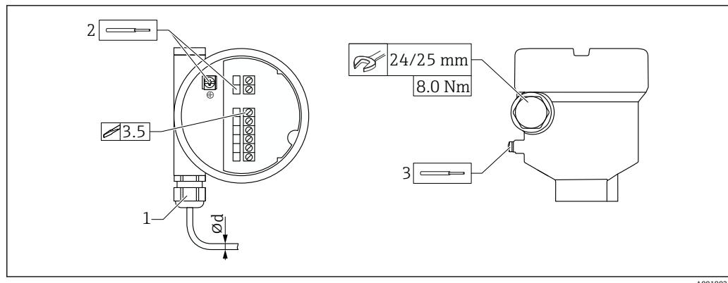
图 31 实例：接头（带电缆入口）和电子插件（带接线端子）
