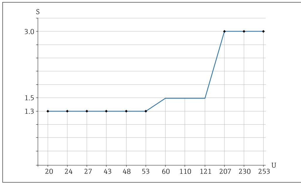
图 18 负载的推荐最小持续功率/额定功率
