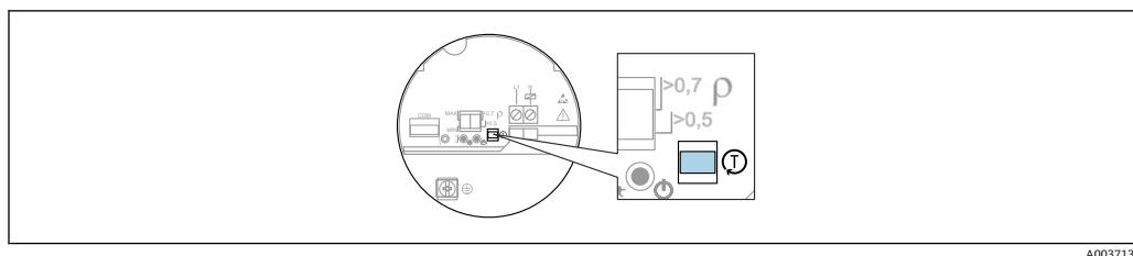
图 34 功能测试按键 (电子插件 FEL61/62/64/64DC/67/68)
