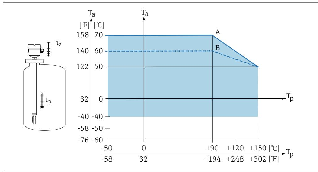
图 52 外壳允许环境温度  $T_a$  与罐体内部过程温度  $T_p$  的关系:
