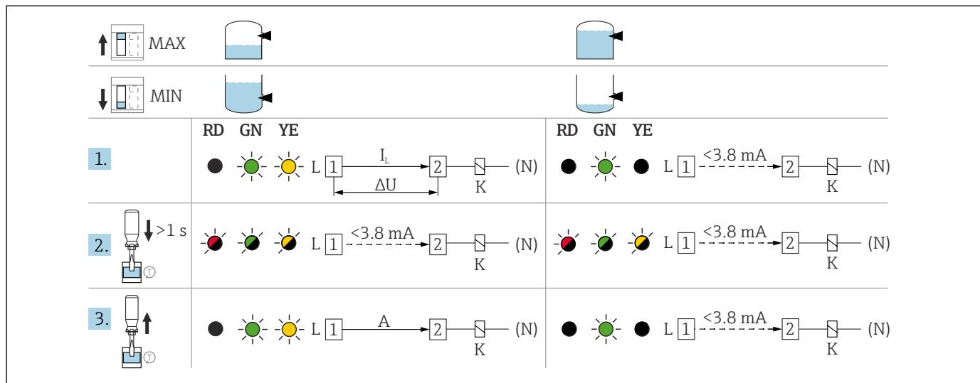
图 35 FEL61 的继电器响应和故障报警信号
