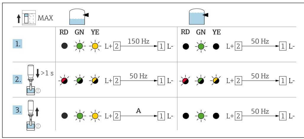
图 38 FEL67 在高限 (MAX) 检测模式下的继电器响应和故障报警信号
