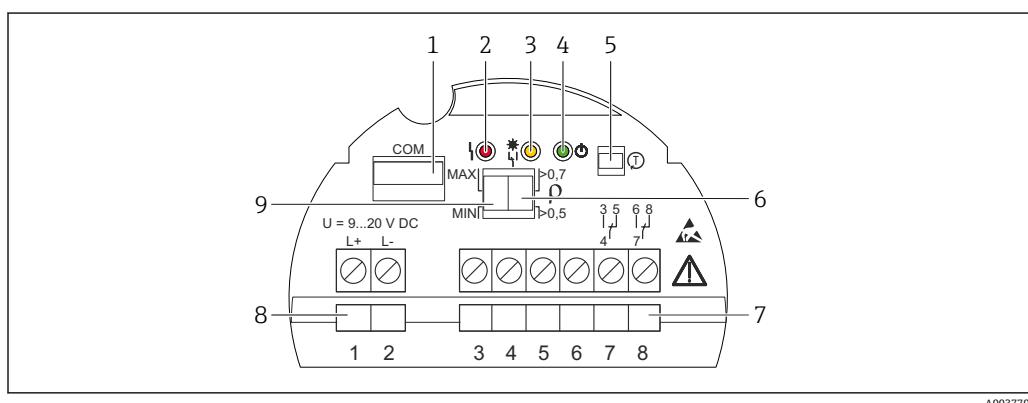
图 32 实例：电子插件 FEL64DC
