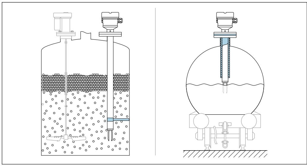
图 9 存在动态负载时，支撑设备的实例
