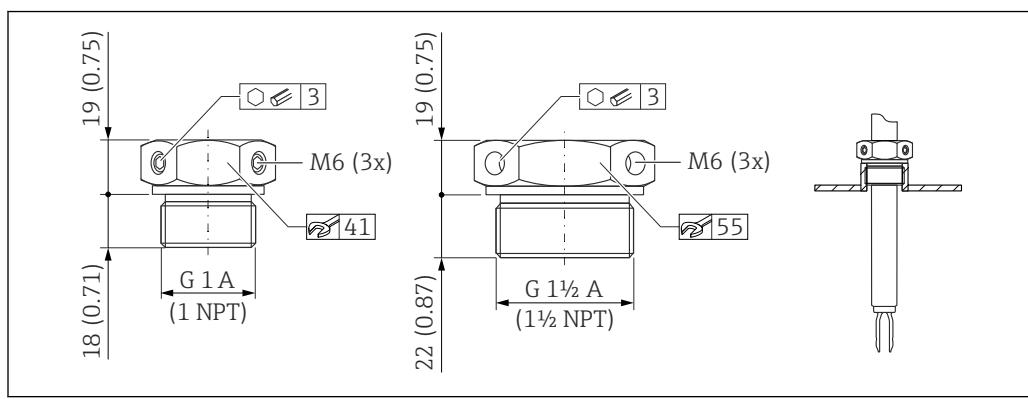
图 50 常压滑动套管  $p_e = 0 \text{ bar (0 psi)}$ 。测量单位 mm (in)
