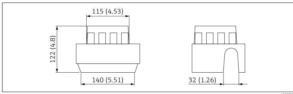
图 45 保护盖，适用单腔室铝外壳或 316L 外壳。测量单位 mm (in)
