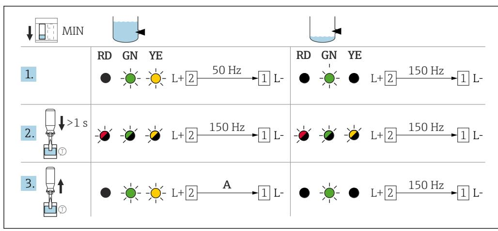
图 39 FEL67 在低限 (MIN) 检测模式下的继电器响应和故障报警信号
