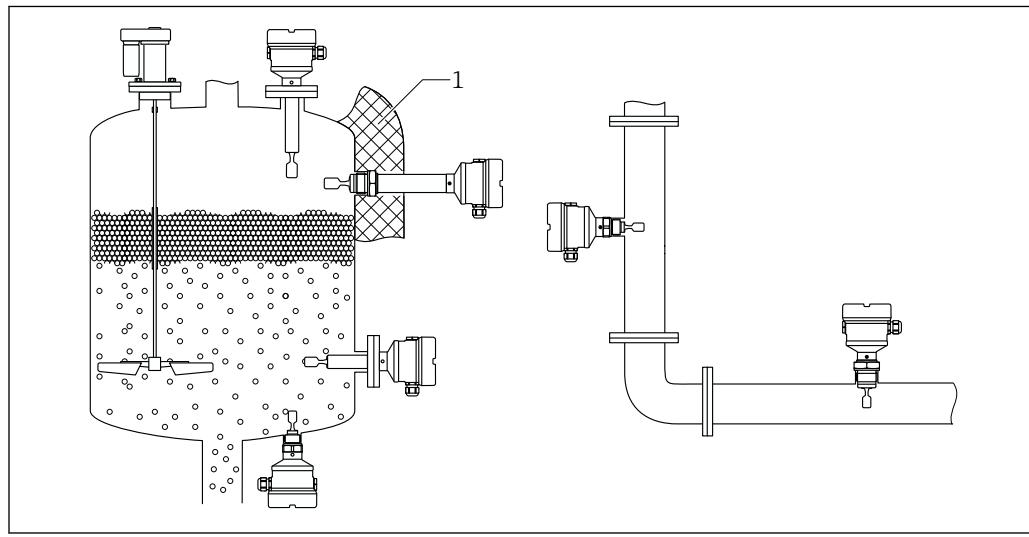
图 3 安装实例：安装在容器、罐体或管道中
