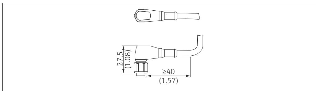
図 59 プラグコネクタ M12 IP69。測定単位 mm (in)
