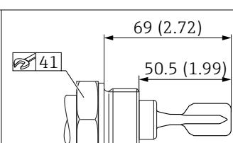
図 42 ネジ接続 ISO228 G 1。測定単位 mm (in)
