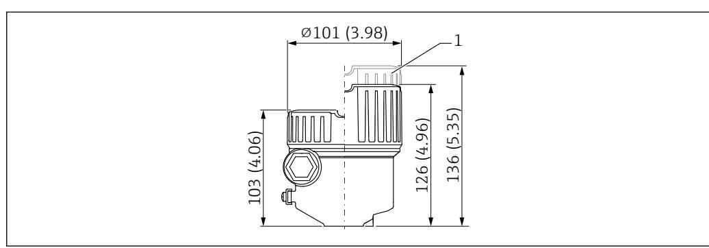
図 33 シングルコンパートメント；アルミニウム、コーティング。測定単位 mm (in)
