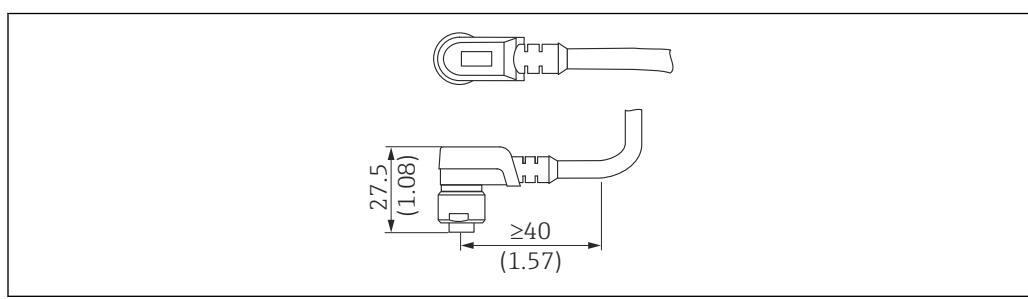
図 60 プラグコネクタ M12 IP67。測定単位 mm (in)
