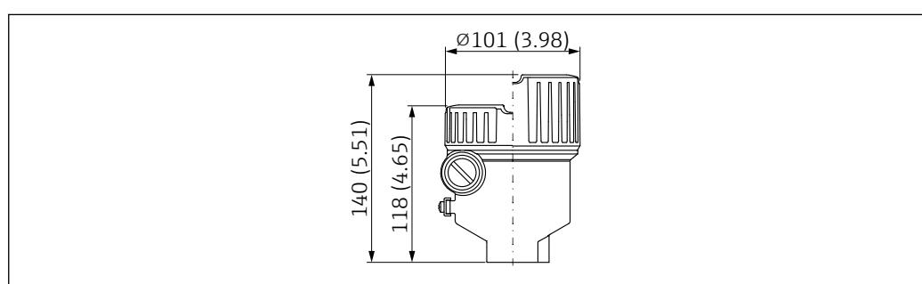
図 32 シングルコンパートメント；アルミニウム、コーティング；Ex d/XP 認定取得。測定単位 mm (in)
