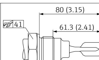
図 40 ネジ接続 ISO228 G 1。測定単位 mm (in)
