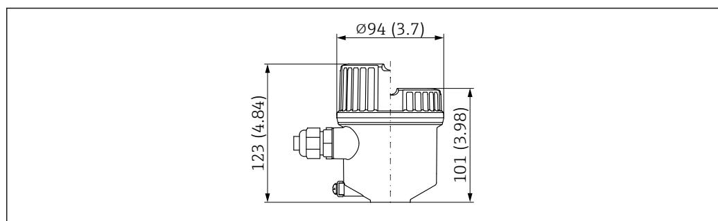
図 31 シングルコンパートメント：プラスチックハウジング。測定単位 mm (in)
