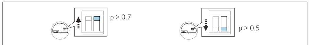
52 电子插件上的密度设置开关
