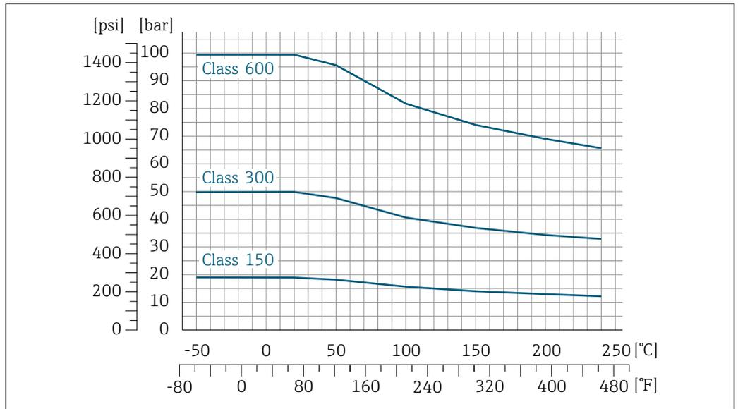
31 Com material do flange 1.4301 (F304), partes úmidas Liga C22
