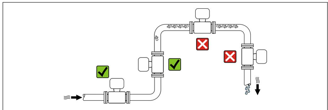
Para evitar erros de medição resultantes do acúmulo de bolhas de gás na tubulação de medição, evite os seguintes locais de instalação na tubulação:
