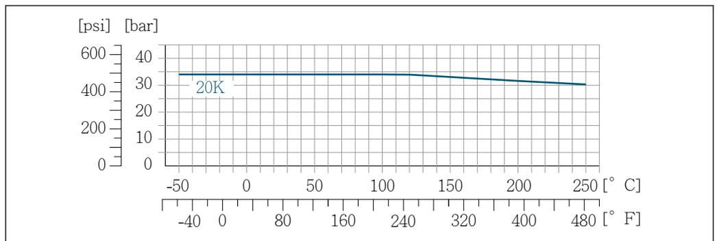
32 Com material do flange 1.4301 (F304), partes úmidas Liga C22
