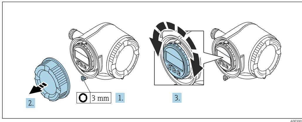
1. Selon la version de l'appareil : desserrer le crampon de sécurité du couvercle du compartiment de raccordement.
