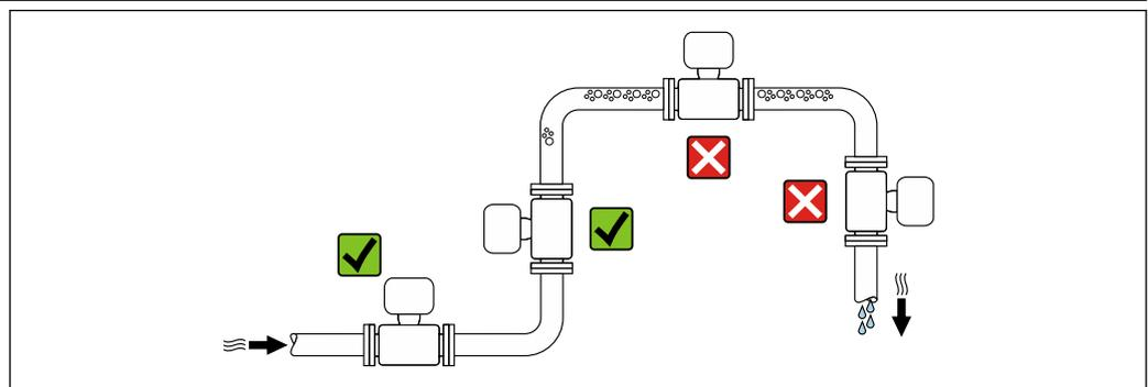
Para evitar que la acumulación de burbujas de gas en la tubería de medición provoque errores de medición, evite los siguientes lugares de montaje en las tuberías:
