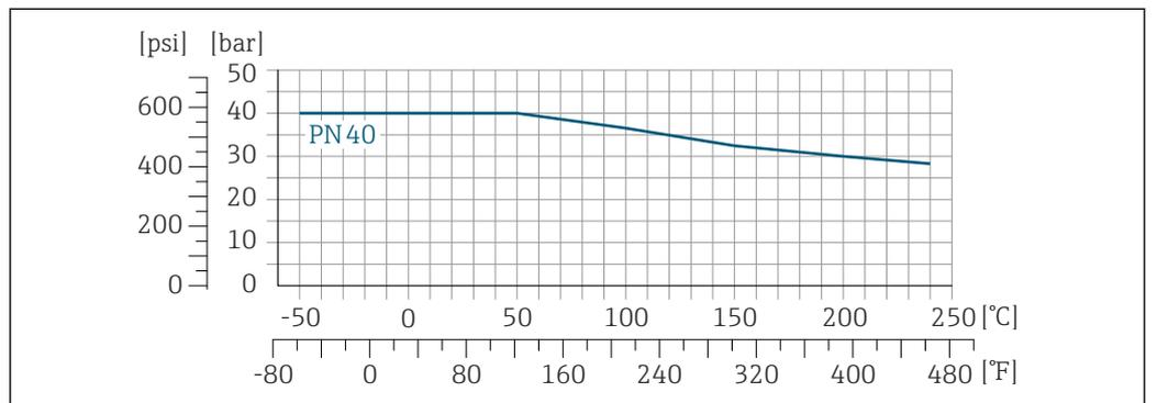
34 Con material de brida 1.4301 (F304); piezas en contacto con el producto Alloy C22
