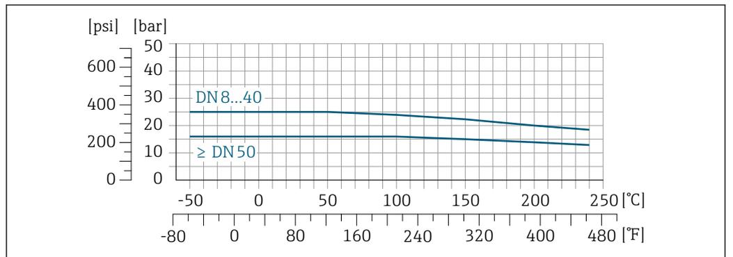
33 Con material de conexión 1.4404 (316/316L)
