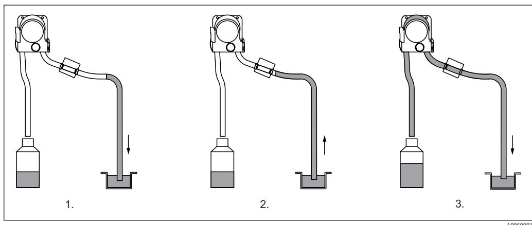
図 3 蠕動式ポンプを使用する場合のサンプリングステップ
