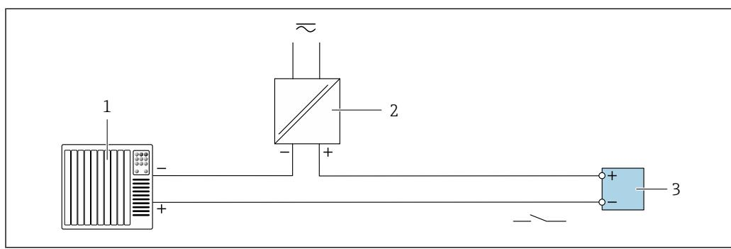
**■ 17 Пример подключения для релейного выхода (пассивного)**
