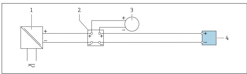
■ 21 Пример подключения для токового входа 4–20 мА
