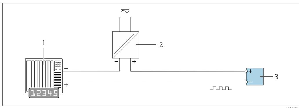
**■ 16 Пример подключения для импульсного/частотного выхода (пассивного)**
