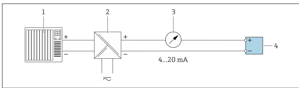
■ 15 Пример подключения для токового выхода 4–20 мА (пассивного)
