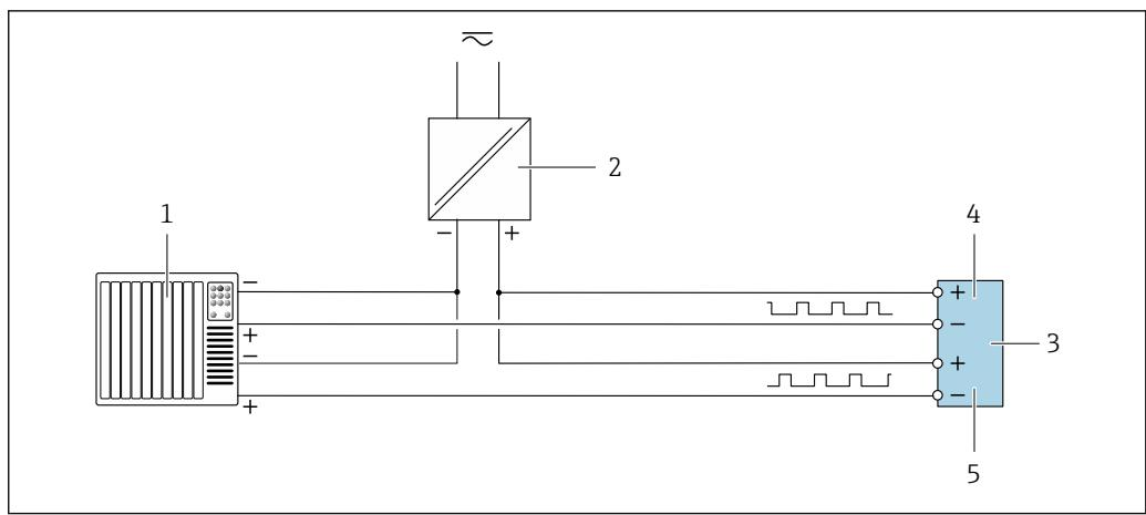
■ 19 Пример подключения двойного импульсного выхода (пассивного)
