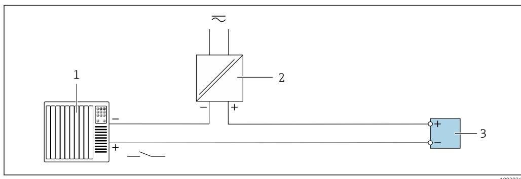
**■ 22 Пример подключения для входного сигнала состояния**
