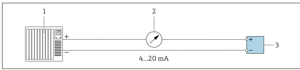
■ 14 Пример подключения для токового выхода 4–20 мА (активного)
