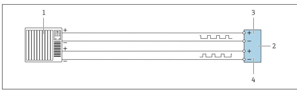
**■ 18 Пример подключения двойного импульсного выхода (активного)**
