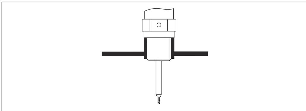
**9** Montage avec raccord fileté ; affleurant avec le plafond de la cuve
