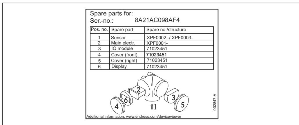
43 Exemple de plaque signalétique des pièces de rechange dans le couvercle du compartiment de raccordement
