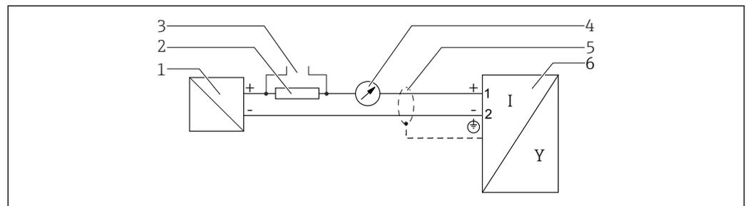
15 Schéma de principe 2 fils : 4-20 mA HART
