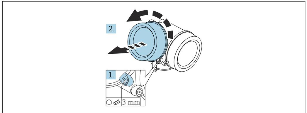
1. Dévisser la vis de la griffe de sécurité du couvercle du compartiment de l'électronique à l'aide d'une clé pour vis six pans (3 mm) et pivoter la griffe de 90 ° dans le sens inverse des aiguilles d'une montre.
