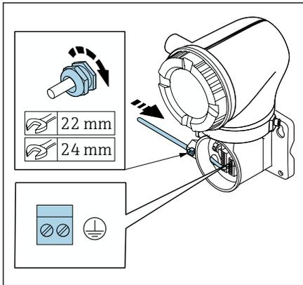
3. コイルケーブルと電極ケーブルを対応する電線管接続口に通します。
