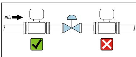
コントロールバルブの上流側の流れ方向に機器を設置します。
