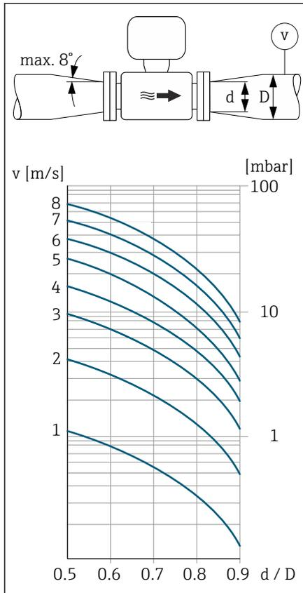
適切なアダプタ（レデューサおよびエキスパンダ）を使用すると、センサをより大口径の配管に設置できます。これにより流量が増加するため、流速の低い測定物の測定精度が向上します。
