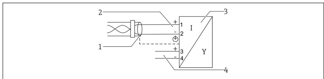
10 Schéma de principe PROFIBUS PA / FOUNDATION Fieldbus
