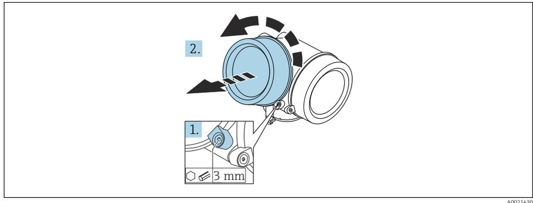
1. Dévisser la vis de la griffe de sécurité du couvercle du compartiment de l'électronique à l'aide d'une clé pour vis six pans (3 mm) et pivoter la griffe de 90 ° dans le sens inverse des aiguilles d'une montre.
