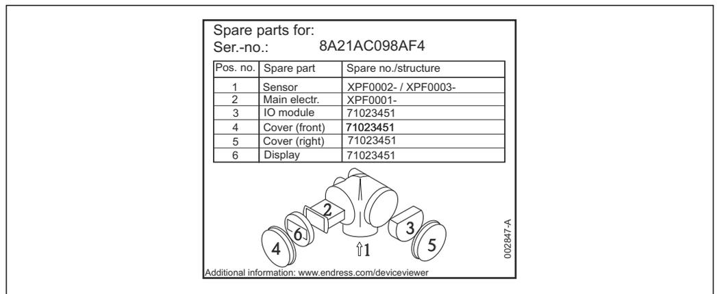
29 Exemple de plaque signalétique dans le couvercle du compartiment de raccordement
