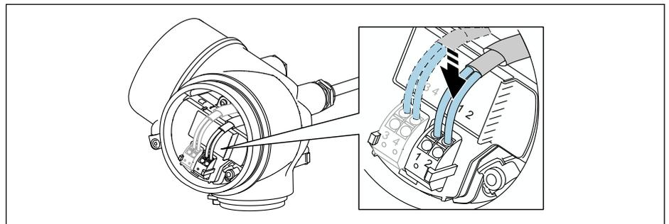
6. En cas d'utilisation de câbles blindés : Raccorder le blindage du câble à la borne de terre.
